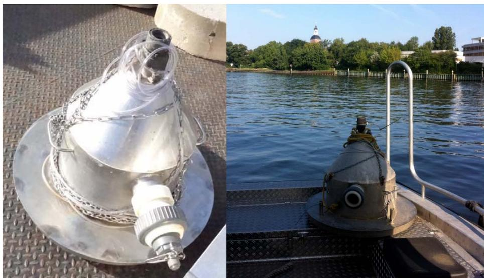
Abbildung 9: verwendete Benthoskammer mit seitlichem Sondenzugang
