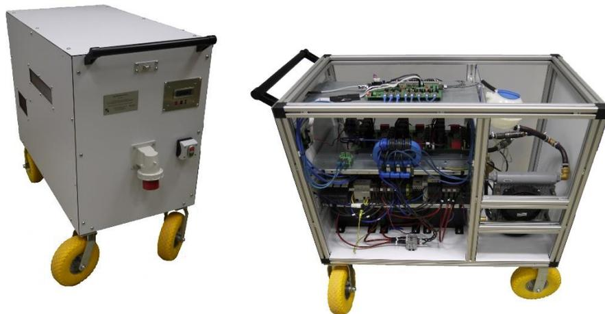
Abb. 2: Fotos des Frequenzumrichters im Rollwagen
