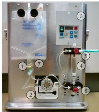
Abbildung 8: Konstruktionszeichnung der Aufkonzentrierungsapparatur (Abbildung 8 a); beschriftete Aufnahme der Aufkonzentrierungsapparatur (Abbildung 8 b): 1. Sterilbeutel mit Probe, 2. Peristaltikpumpe, 3. Steuerungselement, 4. monolithische Affinitätssäule mit PTFE-Fitting, 5. Spritze zur Vorwärtselution, 6. Auslass zum Auffangen des Eluats (vorwärts), 7. Sterilbeutel mit Durchlauf.
