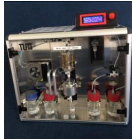
Abbildung 12: Schematische Darstellung der automatischen monolithischen Immunoextraktionsanlage (Auto-MIE) (12 a), Aufnahme der Auto-MIE (12 b).
