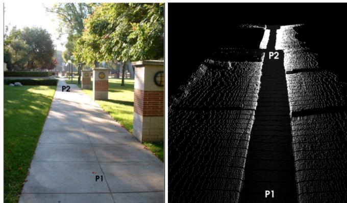
Abbildung A.5 In Wolf [81] erstellte Landkarte mit Hilfe eines SICK Laserscanners. P1 und P2 stellen dabei Referenzpunkte dar, die den gleichen Bildabschnitt kennzeichnen.
