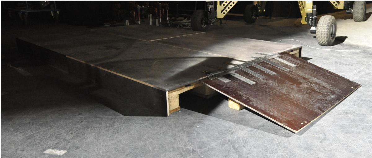
Abbildung 2.24 Szenario Rampe. Das Podest hat mit vier Paletten die Maße  $164 \times 16 \times 244$  ( $B \times H \times T$  in cm). Die Rampe hat die Maße  $64 \times 103$  ( $B \times L$  in cm).
