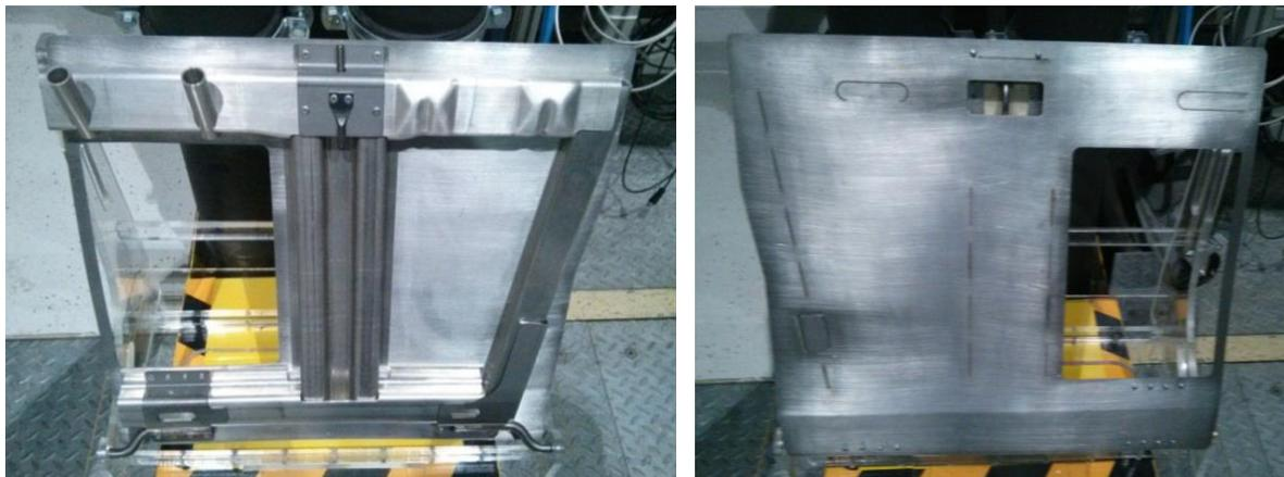
Abbildung 25: Vorder- und Rückansicht der gefügten Rücksitzlehne als Messedemonstrator aus AZ31
