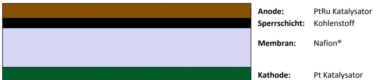
Abbildung 8: Schematische Darstellung einer mehrlagigen Modell-MEA.
