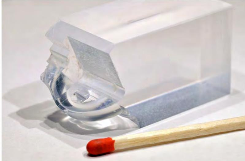
**Abb. 11.2-3: Optische Integrationsplattform (Integrationsstufe 3) in UV optimierten PMMA**
