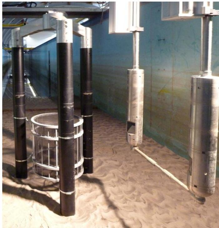
Abb. 63: PIV-Kamerasektionen mit Umlenkspiegel als tauchbares System zur Erfassung der horizontalen Ebenen vor dem TriPile
