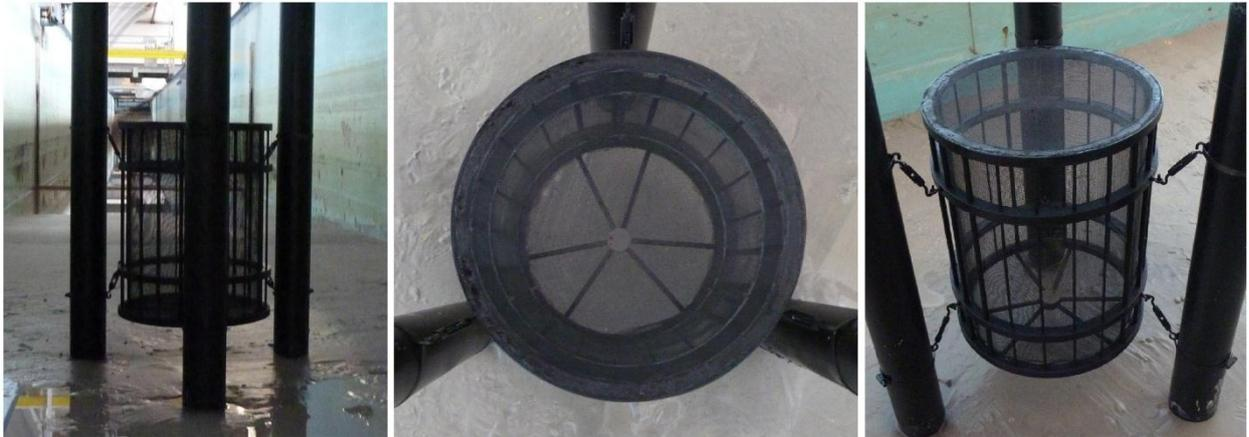
Abb. 71: Darstellung des Versuchsaufbaus mit Einbau des Käfigmodells in den TriPile
