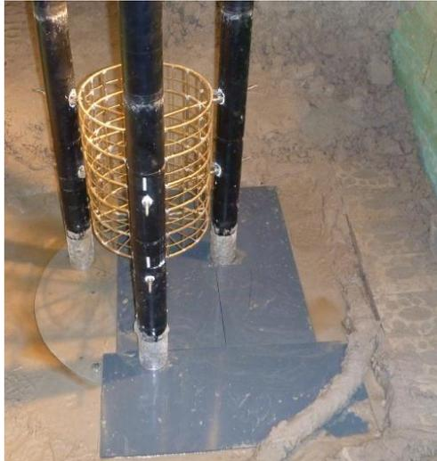
Abb. 67: Modelltechnische Befestigung der Maßstäbchen innerhalb des Sandbettes um den TriPile in vorgebohrten PE-Platten, TriPile mit Zylinder-AKK
