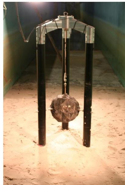
Abb. 76: Darstellung der eingebauten AKK-Varianten, (links) Zylinder-AKK mit einer Netzlage und Wellenangriffsrichtung  $0^\circ$ , (rechts) Kugel-AKK mit einer Netzlage
