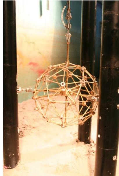
Abb. 77: Befestigung und modelltechnischer Aufbau der AKK-Modelle, (links) Zylinder-AKK, (rechts) Kugel-AKK mit Kraftverteilungsebenen
