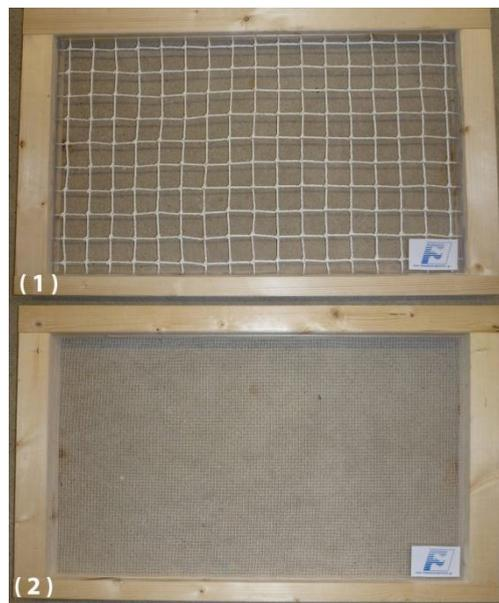
Abb. 53: Konstruktion der Modelle für (1) Netz in 1:1 ; (2) Netz in 1:13,3
