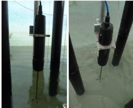
Abb. 64: Darstellung der ADV-Sonde von vorne und schräg oben während einer Messung unterhalb des TriPile-Stützkreuzes
