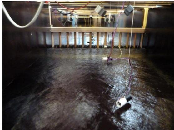
Abb. 55: Beispielhafte Darstellung eines Versuchs mit Rechen im Maßstab 1:2 bei geringem Durchfluss
