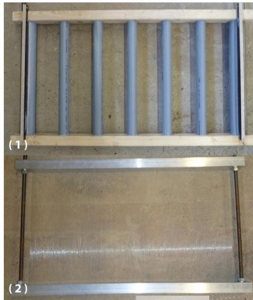
Abb. 52: Konstruktion der Modelle für (1) Rechen in 1:1 ; (2) Rechen in 1:40 aus einfachen Materialien
