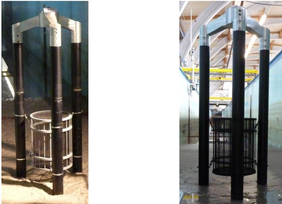
Abb. 70: Darstellung des Zylinderkäfigs sowie der TriPile-Konstruktion im Sandbett des Wellenkanals Schneiderberg
