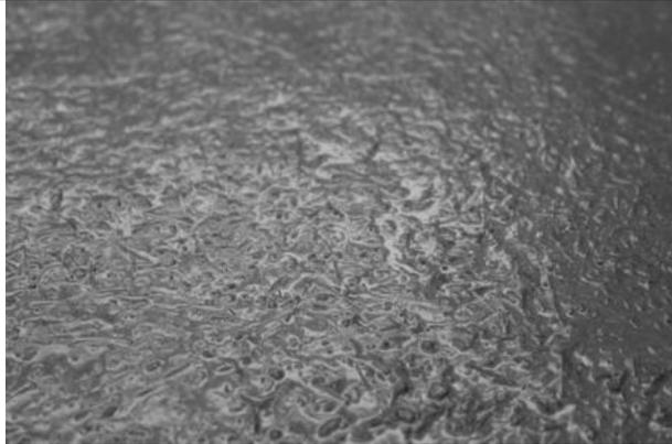
Abbildung 8: Oberflächenstruktur UHPC mit PVA-Fasern
