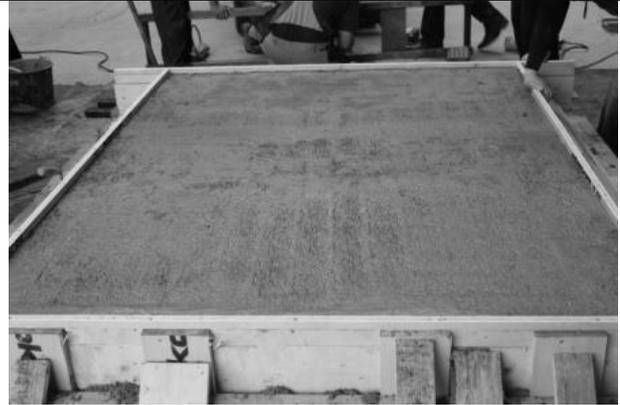
Abbildung 5: Stahlfaserschicht nach Verdichtung
