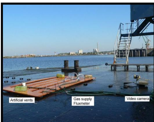
Abb. 5: Versuchsaufbau der künstlichen Gasblasen-austrittsstelle, die 2005 im Marine Arsenal in Kiel aufgebaut wurde.
