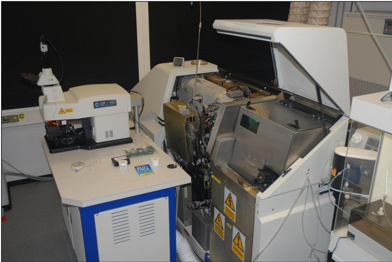
Abb. 10: 193 nm Universal Platform Laser Ablationssystem mit Fast Excimer (FX) - Quelle (links) gekoppelt an das Axiom MC-ICP-MS im Labor für „Low Temperature Isotope Geochemistry“ des IFM-GEOMAR (Arbeitsgruppe: Eisenhauer).
