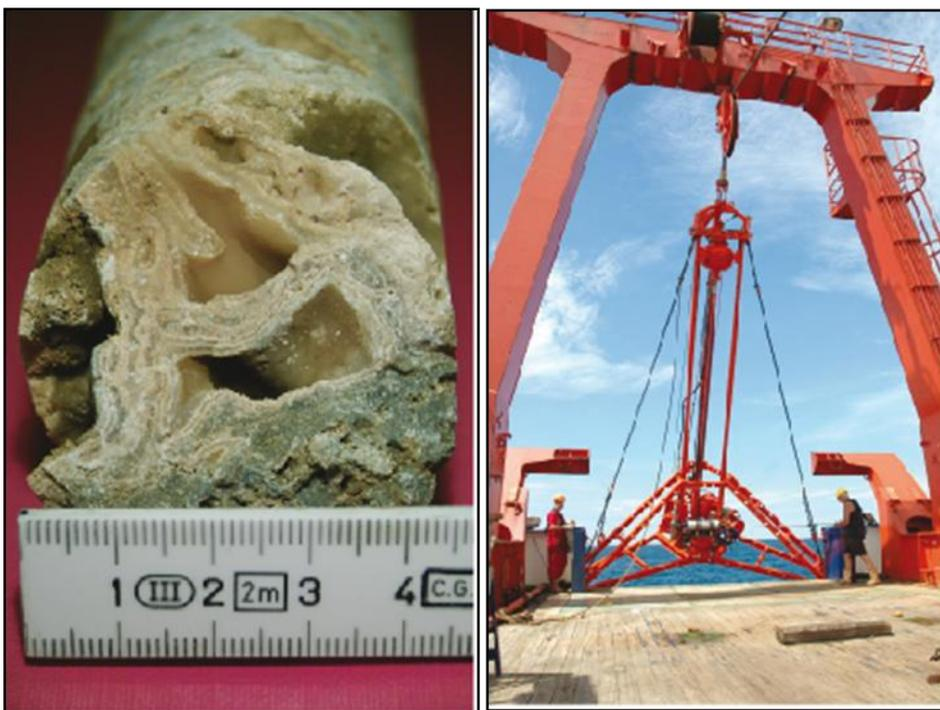
Abb. 4: Charakteristische in-situ Bohrkernproben von Costa Rica (linkes Bild) und BGS-Rockdrill-I Bohrergerät (rechtes Bild).
