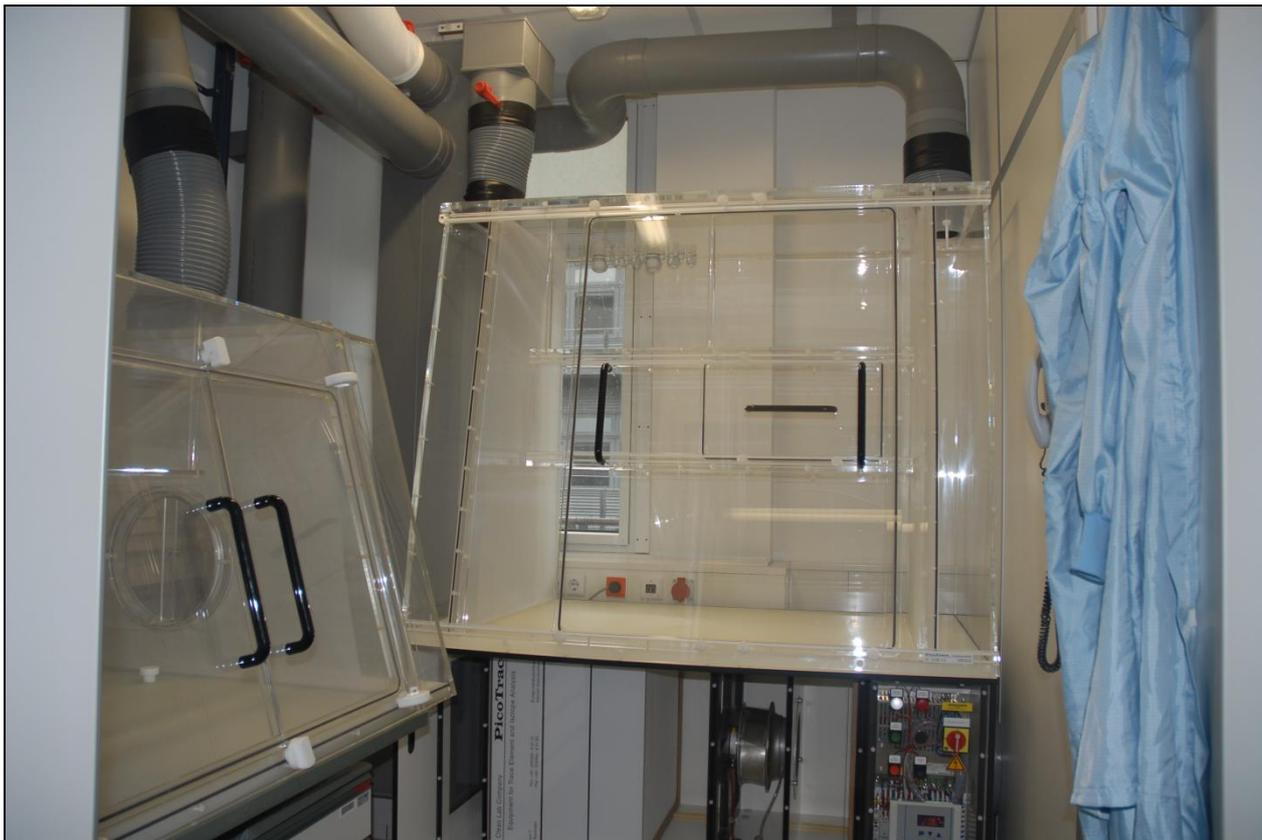
Abb. 12: Low-Blank B-Isotopenlabor mit gesonderter Luftaufbereitung gegen Kontamination durch volatile Komponenten („Future Ocean Cluster“ Univ. Kiel & IFM-GEOMAR) zur isotopengeochemischen Präparation mariner Karbonate für die Rekonstruktion von Paläo-pH-Bildungsbedingungen und low-blank U-Th Analysen zur Altersbestimmung.
