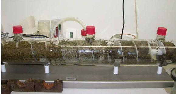
Abb. 5: Schneckenförderer aus Glas
