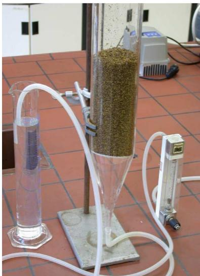
Abb. 12: Versuchsaufbau zur Messung der Druckdifferenz
