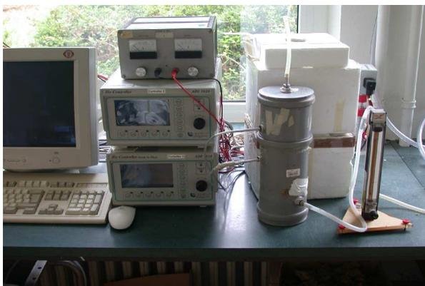
Abb. 14: Apparatur zur Messung der spezifischen biol. Wärmeproduktion
