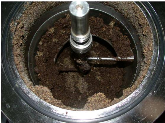
Abb. 10: Rührwendel im Behälter des zylindrischen Bioreaktors
