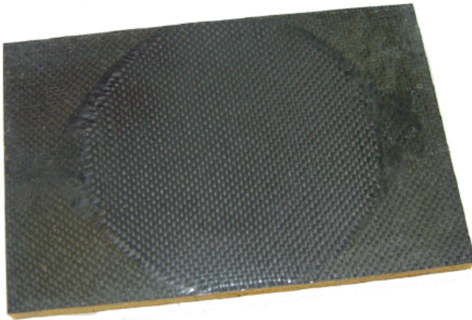
**Abbildung 2.43:** Reparierte Sandwichprobe
