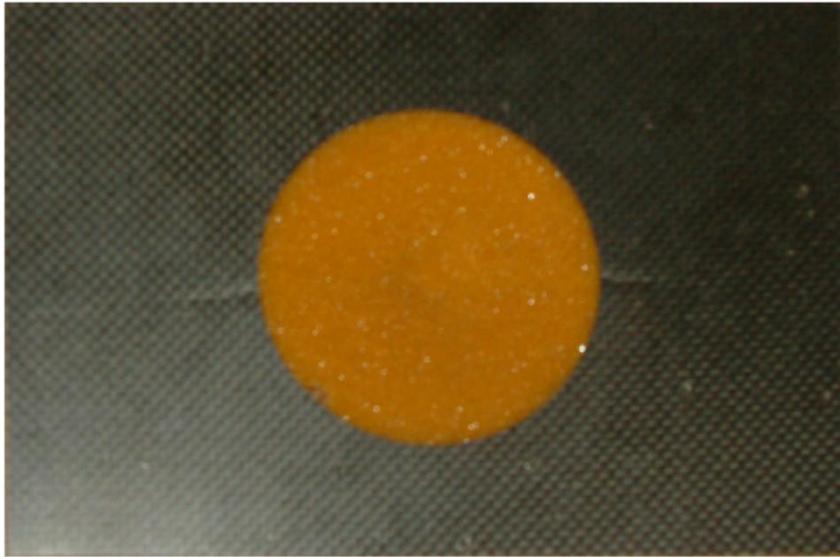
**Abbildung 2.42:** Ausgefräster Impactschaden an einer Sandwichprobe
