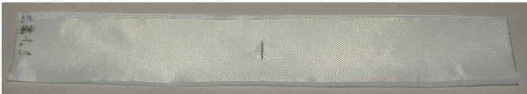
**Abbildung 2.53:** Zugversuchsprobe mit simuliertem Werkzeugschaden
