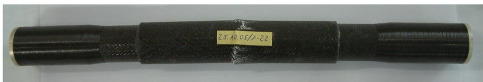
**Abbildung 3.44:** Reparierter Querträgerstab nach Drucktest
