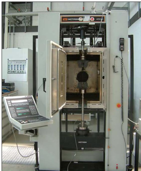
**Abbildung 2.10:** Zugprüfmaschine Instron 4505 mit Klimakammer
