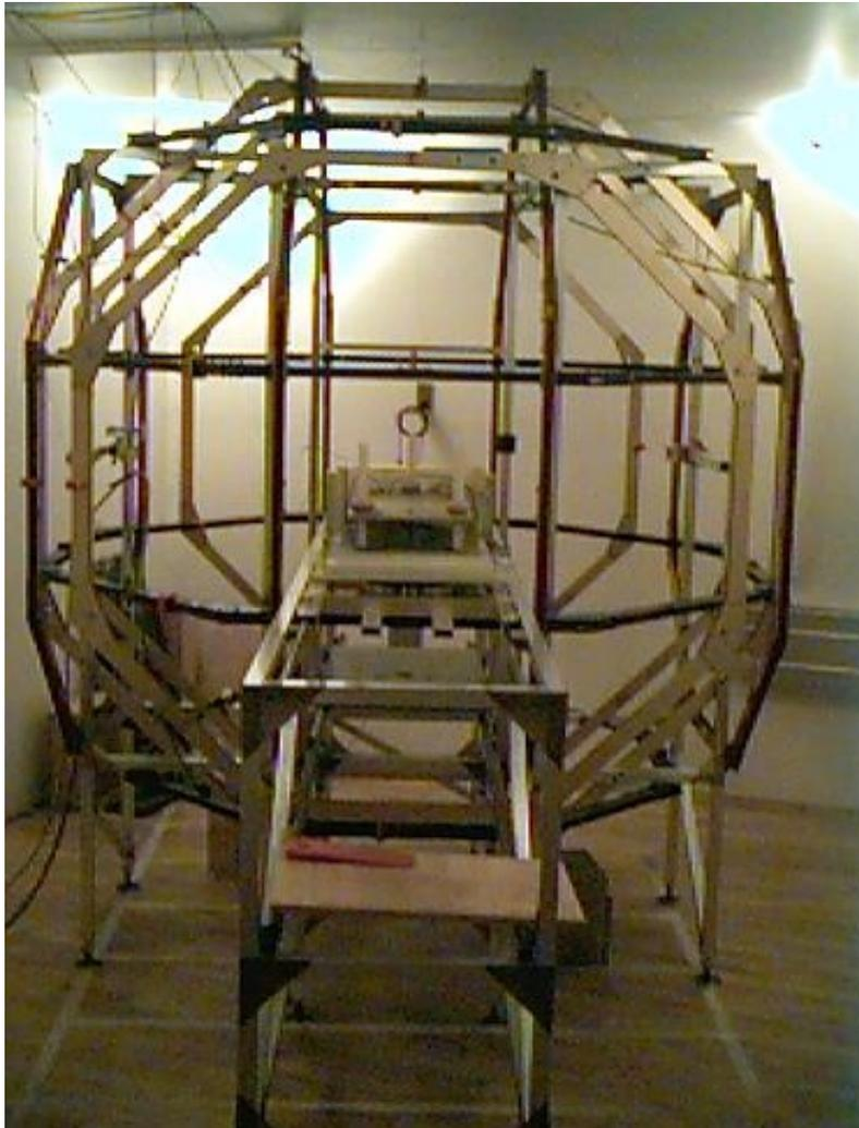
Abb. 5: Das Braunbek-Spulensystem des Kalibrierlabors Magnetsrode
