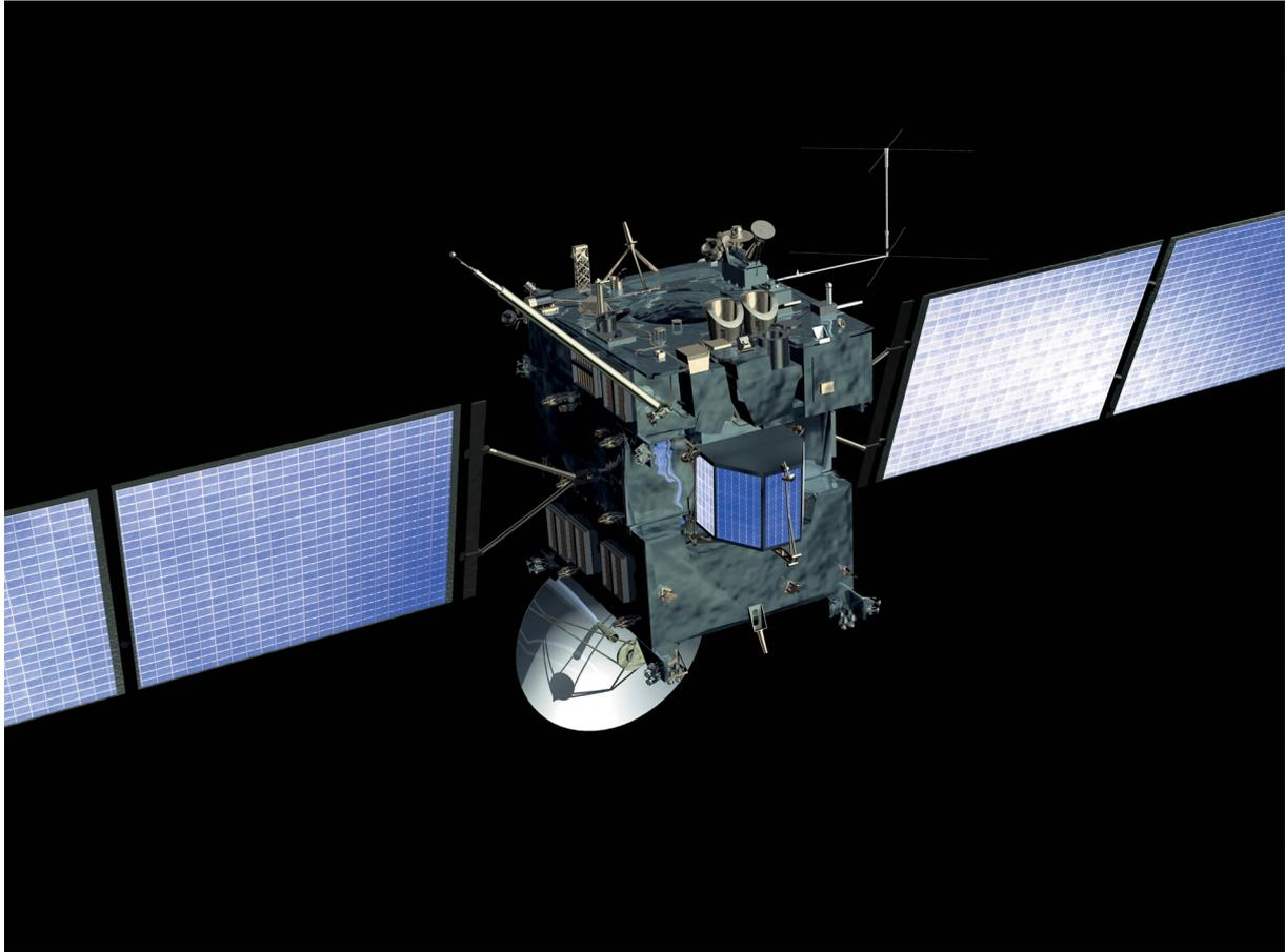
Abb. 2: Das ROSETTA Raumschiff mit dem Landegerät PHILAE
