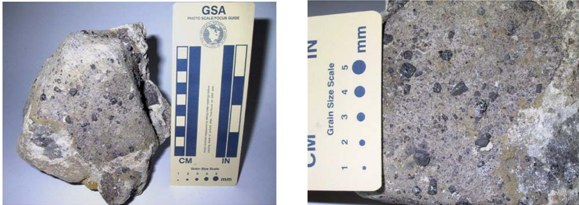
**Abb. 2.3.3:** Handstück der Probe 35 CD. Auffällig sind die großen, herausgewitterten Augitminerale, sowie der gelblich-weiße Zement der Brekzie.
