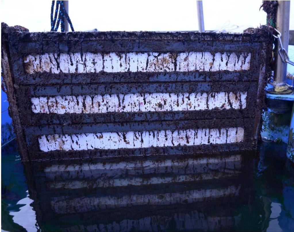
**Abbildung 9:** Rahmenkonstruktion (Design 2020) mit ausgelagerten Proben des Foul-Release-Systems (weiß), die wenige Minuten zuvor aus der Seewasserauslagerung entnommen wurde. Die Proben zeigen einen Bewuchs mit Mikrofoouling und wurden anschließend für die Laserbestrahlung entnommen und mit dem Boot auf Land gebracht.
