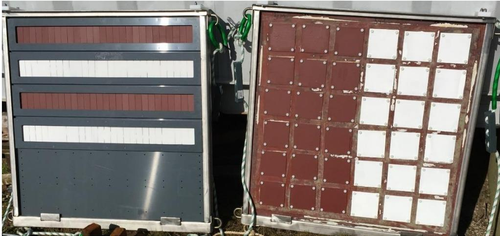
**Abbildung 8:** Basisrahmen (Design 2020) bestückt mit beschichteten Objektträgern (SPC rot) (FRC weiß) (links) sowie Basisrahmen mit beschichteten Stahlproben (Design 2020) (rechts).
