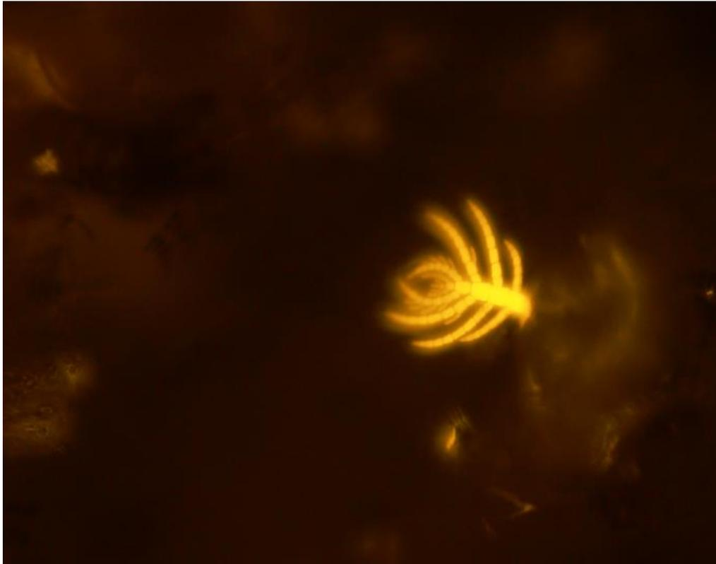
**Abbildung 30:** Fluoreszenzmikroskopische Aufnahme von marinem Fouling auf einer FRC-Probe in 10facher Vergrößerung.
