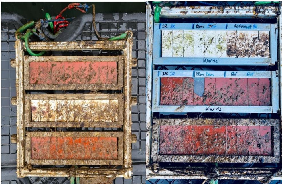
**Abbildung 11:** Kleinerer Auslagerungsrahmen (Design LZH), der in den Herbst und Wintermonaten im Südhafen eingesetzt wurde, um kontinuierlich Probenmaterial vorhalten zu können. Hier ist der Bewuchs auf SPC- und FRC-Proben in KW12 zu sehen. Diese wurden mit unterschiedlichen Laserparametern bestrahlt [rechtes Bild, obere und mittlere Reihe] und in KW 13 erneut inspiziert [Positionierung im Rahmen geändert].
