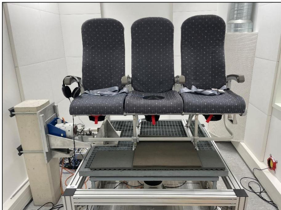
Abbildung 51: Flugzeugkabinensitz auf der Vibrationsplattform der Universität Oldenburg
