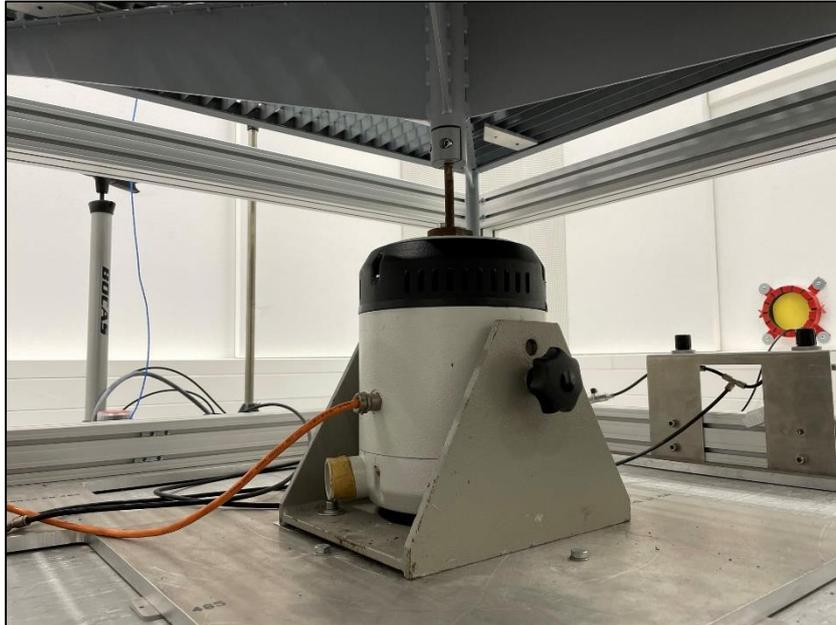
Abbildung 22: Shaker TIRA TV52120. Dieser wird zur vertikalen Anregung der Vibrationsplattform genutzt.
