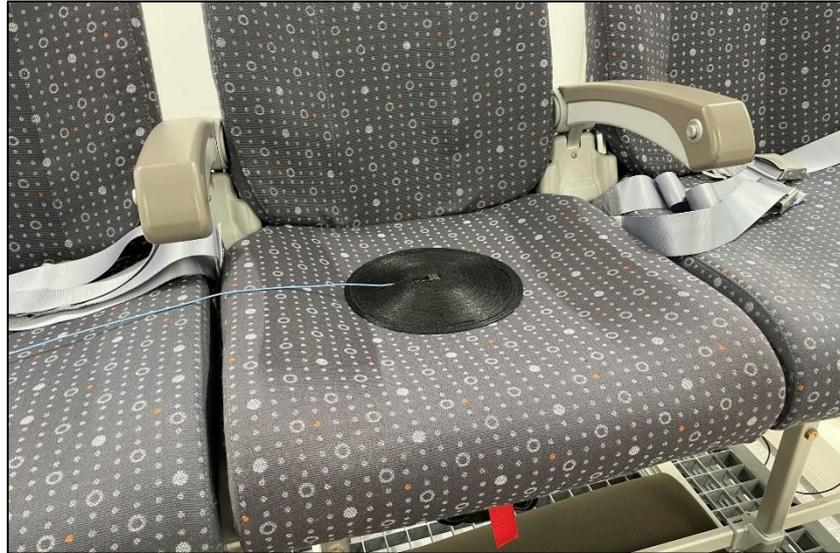
Abbildung 25: Ein eigens von der Universität Oldenburg angefertigtes Sitzpad, welches in der Mitte Platz für einen Beschleunigungssensor (z.B. PCB 356A15) bietet. Dieses Pad dient zur Messung des Beschleunigungspegels von Ganzkörpervibrationen zwischen Sitzfläche und Gesäß einer Versuchsperson.
