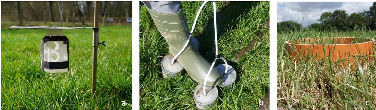
Abbildung 6: Feldmessungen (a) mit Passivsammlern, (b) Messhauben der DTM-Methode und (c) Bodenrahmen für die THG Haubenmessung nach der Gülleausbringung. (© Thünen-Institut/Caroline Buchen-Tschiskale)
