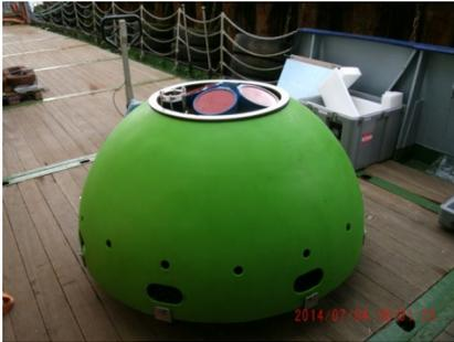
**Abb.1.3.1:** Einer der im Projekt neu angeschafften Verankerungsrahmen für ein 75 kHz Long Ranger ADCP, der auf der Reise P471-2 ausgelegt wurde. Die Konstruktion verhindert, dass die Nebenkeulen des akustischen Signals während der Messung den Boden erreichen und die Strömungsgeschwindigkeiten verfälschen. Außerdem schützt der Rahmen vor Eisdrift und Fischerei.
