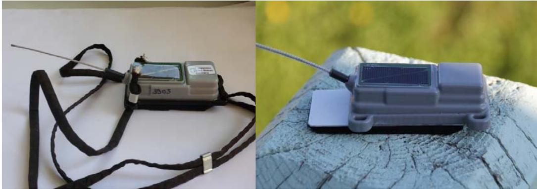
Abb. 3: Solarbetriebene GPS-Datenlogger „Solar-GPS-ACC“ (e-obs GmbH, Grünwald); links: für Heringsmöwen verwendete Version; rechts: für Basstölpel genutzte Version.
