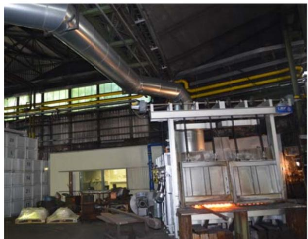
**Bild 26:** Anschlussleitung des Ofens 1 (links) und Ansicht des 30-Zentner-Ofens (Ofen 13) mit Abgasleitung (rechts)
