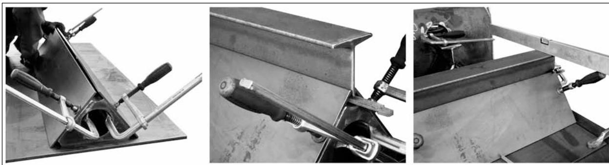
**Bild 61:** Prüfkörperfertigung: Fixierung der Bleche durch die Hilfskonstruktion Pos. 601, Einpassung des 1/2 I-Profils bezüglich der Höhenlage, Ausrichten des 1/2 I-Profils mithilfe eine Wasserwaage
