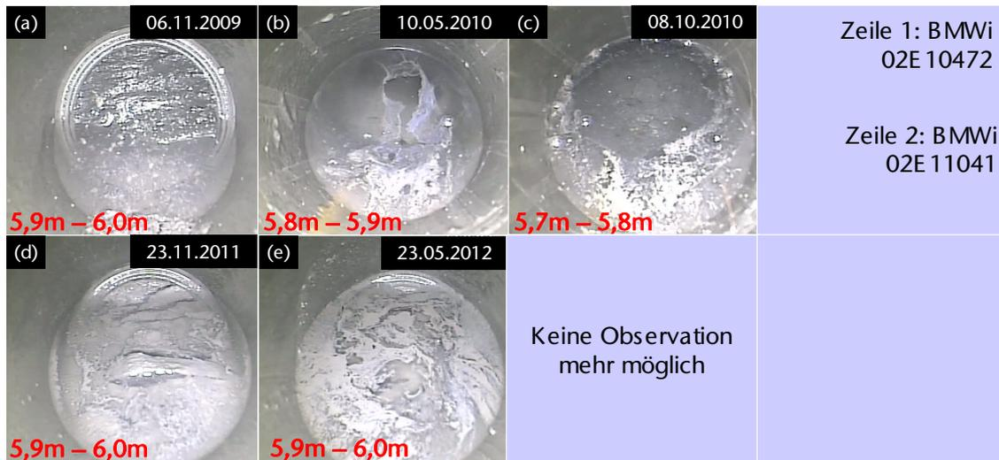
Bild 3.103: Dokumentation der zeitabhängigen Entwicklung der Bohrlochkontur im Teufenbereich unmittelbar am Bohrlochtiefsten innerhalb des Observationszeitraums vom 06.11.2009 bis zum 23.05.2012 mit einem vorübergehenden Anstieg des Sickerwasserspiegels
