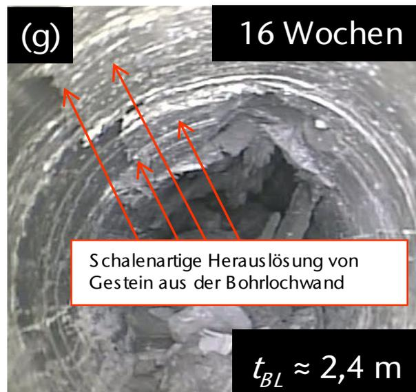
*Bild 3.48: Herauslösung von schalenartig zusammenhängendem Gestein aus der Bohrlochwand mit einer Bruchkante in dem Bereich der Bohrlochkontur, in dem die Schichtflächen die Bohrlochkontur tangential berühren*
