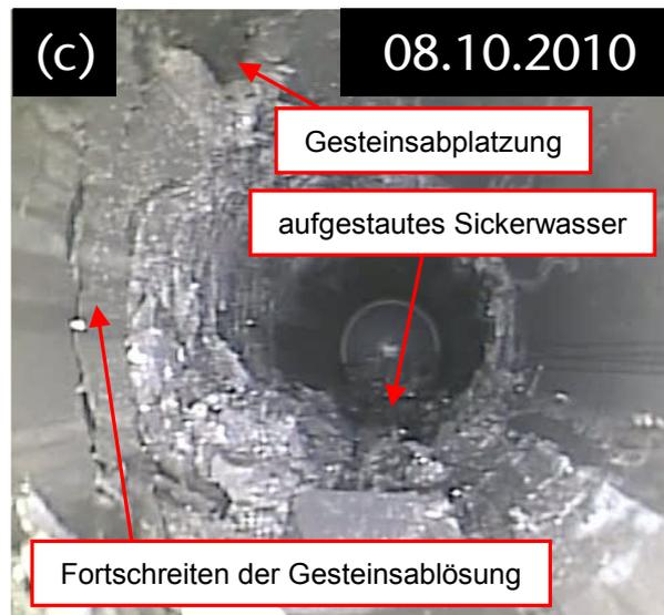
Bild 3.98: Vergrößerte Darstellung von Bild 3.96(c) mit einer grafischen Kennzeichnung von einer Gesteinsabplatzung im Firstbereich, einer fortschreitenden Herauslösung von Gestein aus der Bohrlochwand heraus sowie von aufgestautem Sickerwasser im hinteren Teufenbereich des Bohrlochs GSM 90, Lux et al. (2012)
