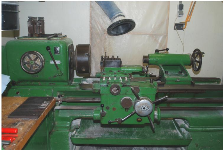
*Bild 4.3: Drehbank zur Herstellung von Gesteinsprüfkörpern am Lehrstuhl für Deponietechnik und Geomechanik*
