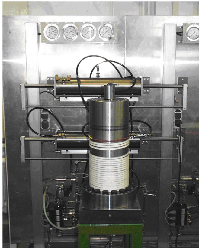
Bild 4.16: Triaxialprüfanlage des Lehrstuhls für Deponietechnik und Geomechanik
