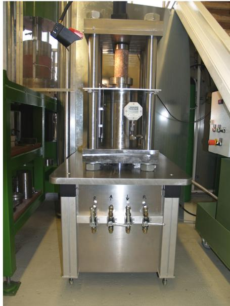
Bild 4.4: 250 kN-Druckprüfanlage des Lehrstuhls für Deponietechnik und Geomechanik
