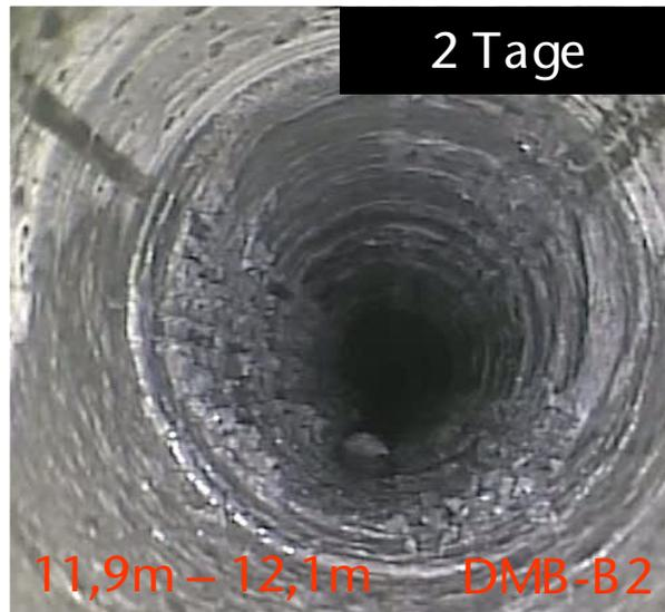
*Bild 3.60: Zutritt von Sickerwasser aus dem innerhalb der sandigen Fazies gelegenen Teufenbereich in den innerhalb der karbonatreichen Fazies gelegenen Teufenbereich 2 Tage nach dem Abteufen des Bohrlochs DMB-B2*
