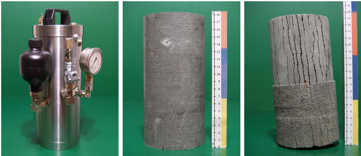
Bild 2.3: Fotografische Ansicht des Zwischenlagerungsbehälters und seiner Wirkungsweise (Tongesteinsbohrkern mit/ohne Zwischenlagerung im Druckbehälter)
