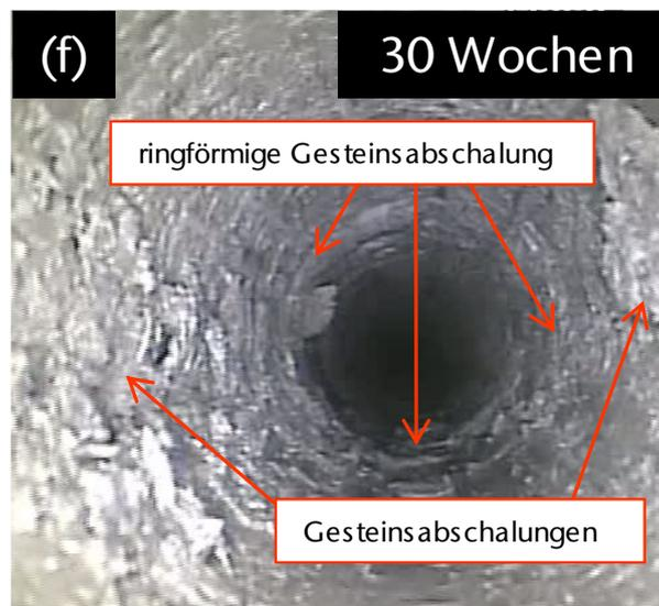
*Bild 3.24: Grafische Kennzeichnung der ringförmigen Gesteinsabschalung sowie der sich andeutenden weiteren Gesteinsabschalungen in den Stoßbereichen im Teufenbereich von  $t_{BL} \approx 5,0$  m bis  $t_{BL} \approx 5,2$  m des Bohrlochs DMB-B2 zum Ende des 30-wöchigen Observationszeitraums*
