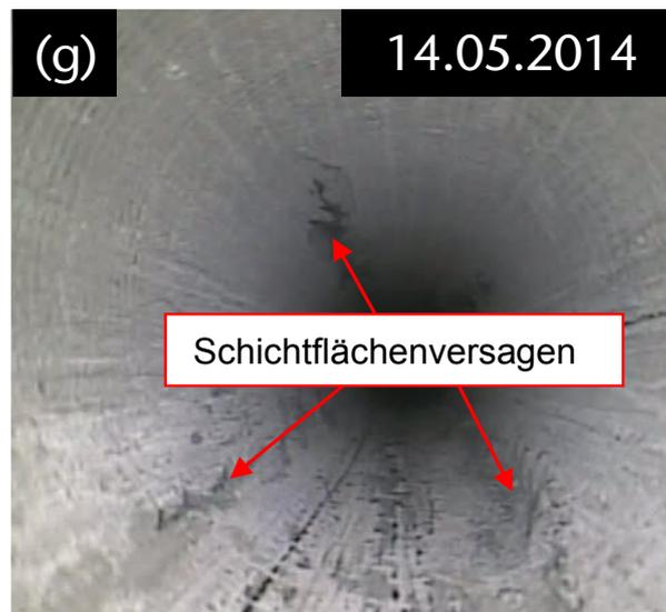
*Bild 3.73: Vergrößerte Darstellung von Bild 3.72(g) mit grafischer Kennzeichnung von Schichtflächenversagen im rechten unteren Konturbereich (Vordergrund) und im linken oberen sowie im linken unteren Konturbereich (Hintergrund)*
