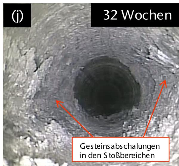
*Bild 3.37: Stark ausgeprägte Gesteinsabschalungen in den Stoßbereichen zum Ende des Observationszeitraums im Teufenbereich von  $t_{BL} \approx 8,3$  m bis  $t_{BL} \approx 8,5$  m*
