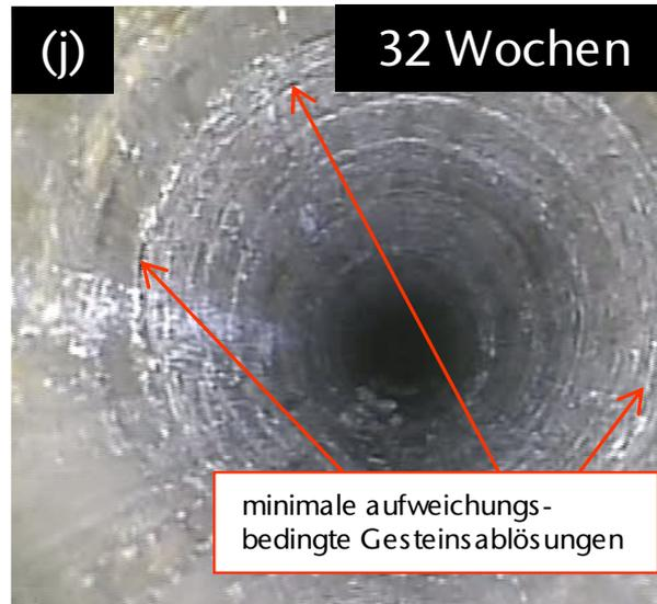
*Bild 3.41: Minimale aufweichungsbedingte Gesteinsablösungen aus der Bohrlochwand heraus im Bereich von präexistenter Strukturen im Tiefenbereich von  $t_{BL} \approx 10,2$  m bis  $t_{BL} \approx 10,4$  m zum Observationszeitpunkt 32 Wochen nach dem Abteufen des Bohrlochs DMB-B3*
