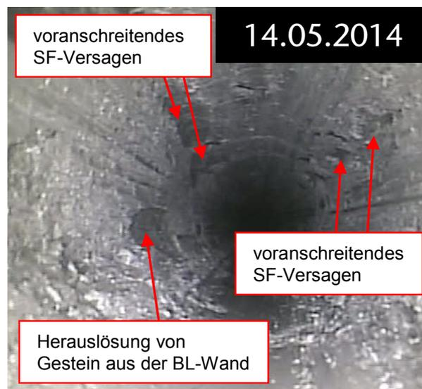
*Bild 3.80: Vergrößerte Darstellung von Bild 3.78(g) mit einer Kennzeichnung von weiter in Richtung des Bohrlochtiefsten voranschreitendem Schichtflächenversagen im linken oberen Bereich der Bohrlochkontur sowie von sich in die entgegengesetzte Richtung ausbreitendem Schichtflächenversagen im rechten oberen Bereich der Bohrlochkontur und der Kennzeichnung einer größeren Gesteinsherauslösung im linken unteren Bereich der Bohrlochkontur*
