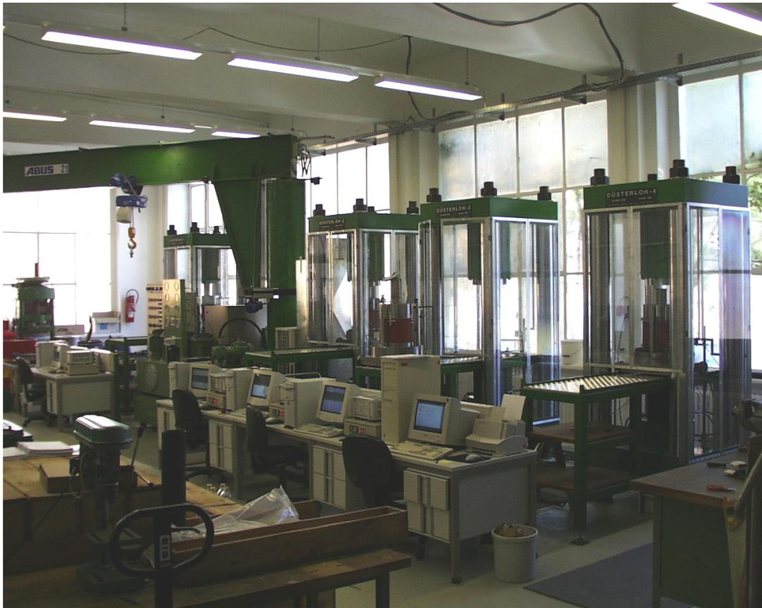
*Bild 4.8: 2500 kN-Druckprüfanlagen des Lehrstuhls für Deponietechnik und Geomechanik*
