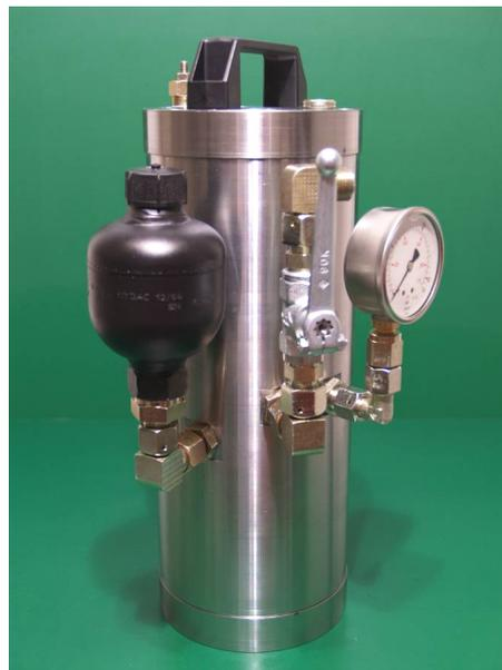
*Bild 4.2: Triaxialdruckzelle zur Konservierung von Tongesteinsprüfkörpern des Lehrstuhls für Deponietechnik und Geomechanik, Czaikowski & Lux (2008)*
