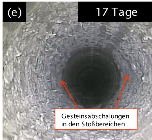
*Bild 3.36: Zustand der Bohrlochwand im Teufenbereich von  $t_{BL} \approx 8,3$  m bis  $t_{BL} \approx 8,5$  m zum Observationszeitpunkt 17 Tage nach dem Abteufen des Bohrlochs DMB-B3 mit der grafischen Hervorhebung von Gesteinsabschalungen in den Bohrlochstoßbereichen im Bereich der tonigen Fazies*
