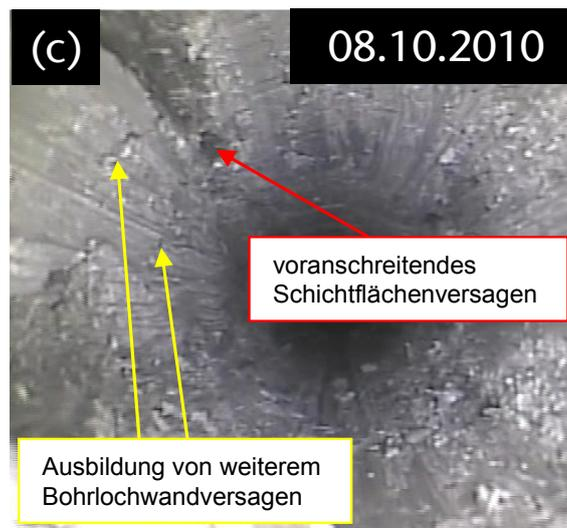
*Bild 3.79: Vergrößerte Darstellung von Bild 3.78(c) mit einer Kennzeichnung des voranschreitenden Schichtflächenversagens im linken oberen Bereich der Bohrlochkontur (roter Pfeil) sowie mit der Kennzeichnung von sich im linken Bereich der Bohrlochkontur ausbildenden Rissstrukturen, die den Beginn der Entwicklung eines weiteren Bohrlochkonturversagens darstellen (gelbe Pfeile), Lux et al. (2012)*
