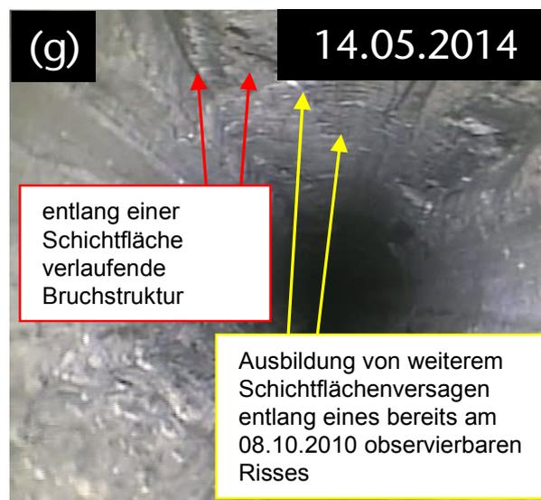
*Bild 3.77: Vergrößerte Darstellung von Bild 3.75(g) mit einer Kennzeichnung der nahezu horizontal entlang einer Schichtfläche verlaufenden Bruchstruktur im linken oberen Bohrlochkonturbereich (rote Pfeile) und der Kennzeichnung des bereits in Bild 3.76 grafisch hervorgehobenen Risses, entlang dessen die Ausbildung von weiterem Schichtflächenversagen zeitabhängig in tiefere Bohrlochbereiche voranschreitet (gelbe Pfeile)*
