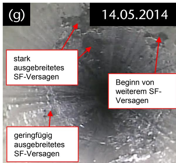
*Bild 3.83: Vergrößerte Darstellung von Bild 3.81(g) mit einer Kennzeichnung von stark ausgeprägtem schichtflächenbedingtem Bohrlochwandversagen im linken oberen Bereich der Bohrlochkontur sowie mit der Kennzeichnung von zwischen dem 08.10.2010 und dem 14.05.2014 nur geringfügig angewachsenem schichtflächenbedingtem Bohrlochwandversagen im linken unteren Bereich der Bohrlochkontur und erst zum 23.05.2012 observierbarem Versagen des Gesteins in den Schichtflächen im rechten oberen Konturbereich*
