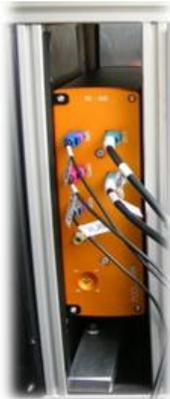
Abbildung 22: Central Kommunikation Unit (CCU) im Versuchsträger integriert
