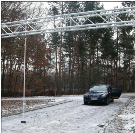
Eine Teilaufgabe war die Integration der Sensoren und der Datenaufzeichnung. Testaufnahmen mit einer sog. „Sync-Box“ wurden durchgeführt (Siehe Abbildung 26), um die GNSS basierte Zeitstempelung der Sensordaten zu evaluieren. Dabei konnten auch schon erste Aussagen über die Latenzzeiten der Sensoren gewonnen werden.
