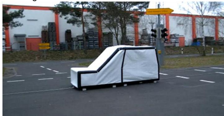
Abbildung 33: Target für den Querverkehr, CSEI Testgelände City
