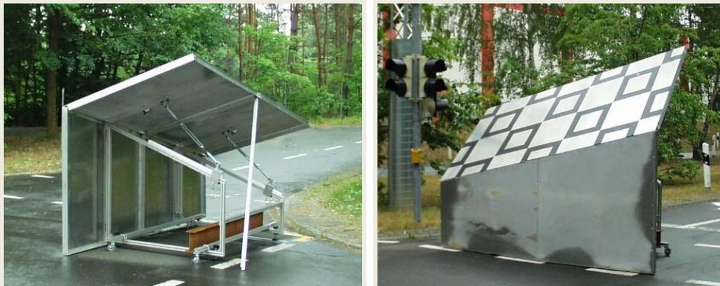
Abbildung 11: Kalibrierobjekt für Laserscanner und Kamera
