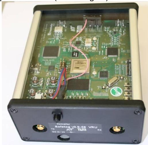
Abbildung 14: Ko-TAG v1.0, Anschlüsse TX (links), Power (Mitte unten), RX (rechts)
