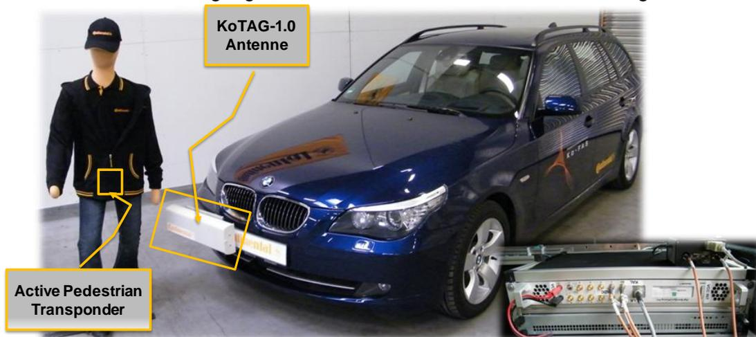
Abbildung 20: Fußgängerschutzsystem mit Transpondertechnologie
