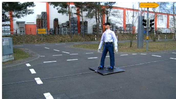
Abbildung 36: Fußgängerdummy, CSEI Testgelände City
