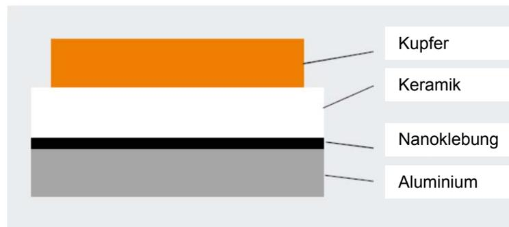
**Abbildung 4-11: Aufbau Keramik-Substrat mit rückseitig verklebter Aluminiumschicht (Bild: Curamik)**
