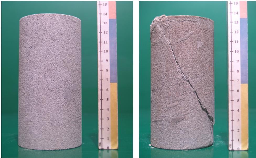
Bild 5.31: Sandsteinprüfkörper Har-San-42 vor und nach der Versuchsdurchführung
