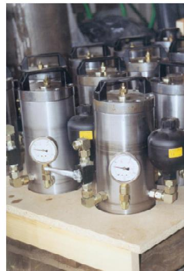
*Bild 3.4: Einbau von Gesteinsbohrkernen in Lagerungsbehälter*
