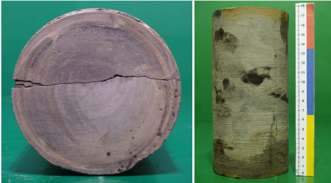
*Bild 5.34: Prüfkörper Tou-45 nach Ausbau aus dem Aufsättigungsbehälter und vor Einbau in die erweiterte Triaxialprüfanlage (links) sowie nach Ausbau aus der erweiterten Triaxialprüfanlage (rechts)*
