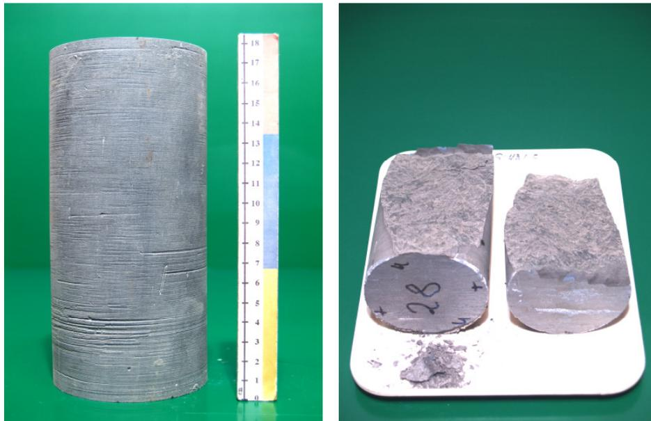
*Bild 5.2: Tongesteinsprüfkörper Tou-28 vor und nach der Versuchsdurchführung mit der Hauptbelastungsrichtung parallel zum Schichtungsverlauf*
