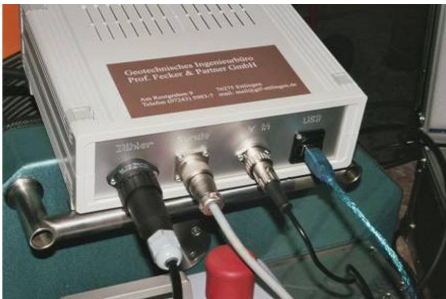
*Bild 4.15: Datenerfassungseinheit für die Kalibersonde*
