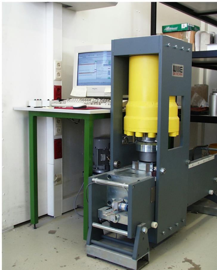
*Bild 5.14: Rahmenschergerät der Firma Wille Geotechnik*
