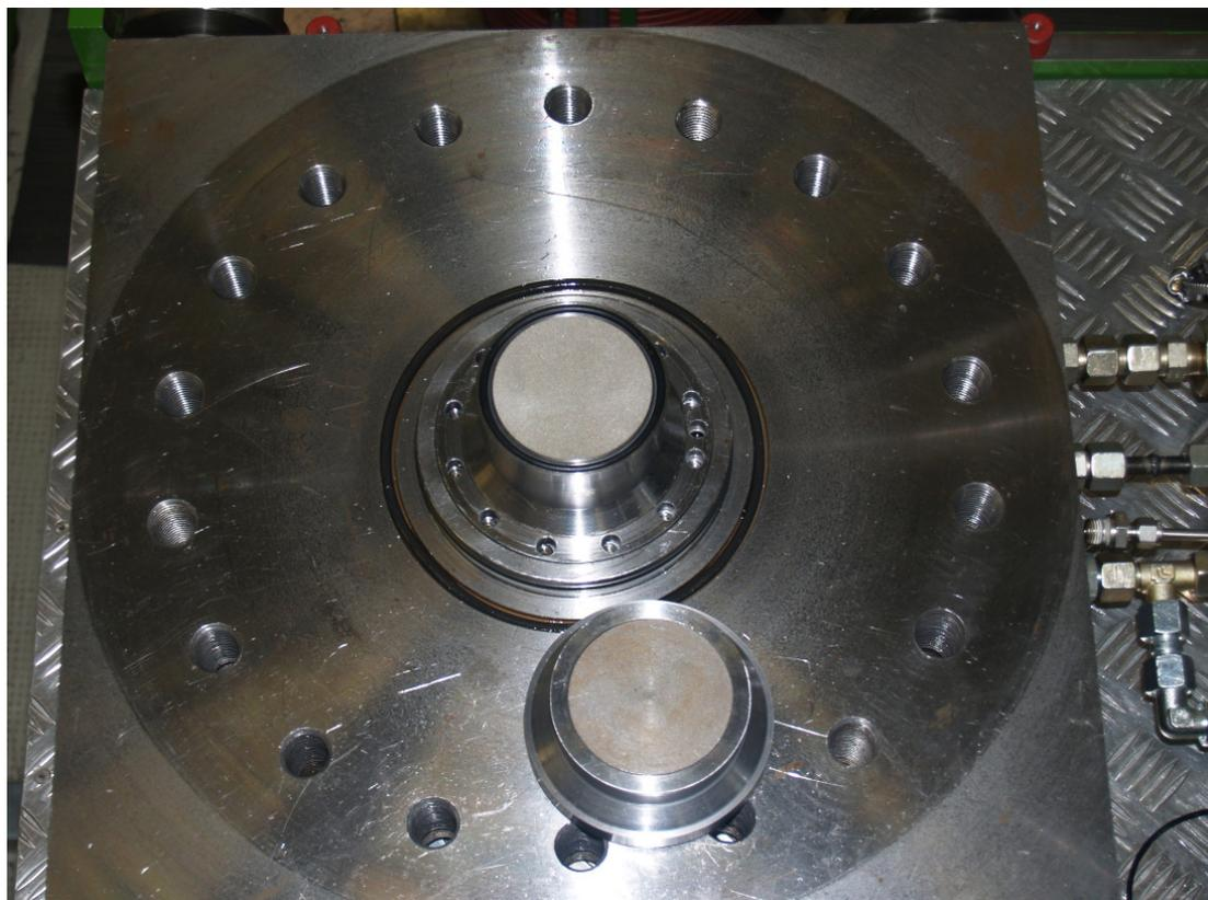
*Bild 5.29: Modifizierte Druckstücke mit Fluidzuleitung (obere Darstellung) und Fritte (untere Darstellung)*
