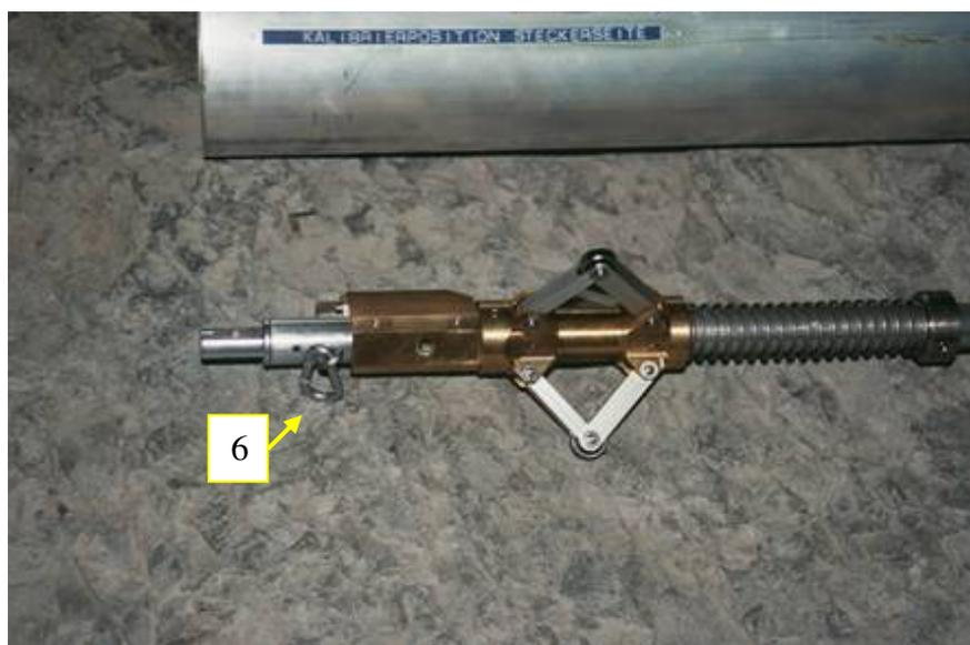
*Bild 4.14: Zentriermechanismus mit Karabinerhaken zum Anschluss des Tiefenzählers am Fuß der Kalibersonde*
