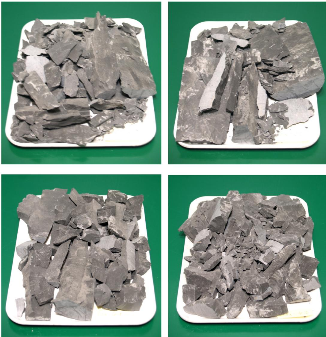
Bild 5.23: P-Prüfkörper Tou-38 und Tou-39 (oben links bzw. rechts) sowie S-Prüfkörper Tou-41 und Tou-42 (unten links bzw. rechts) nach den UCc-Versuchen
