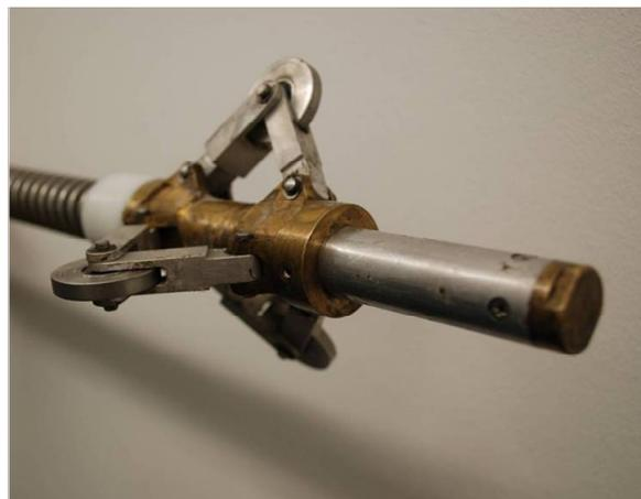
*Bild 4.12: Messmechanismus der Dreiarmkalibersonde der TUC mit größeren Rollen und verstärkten Kniehebeln nach dem Umbau im Mai 2009*
