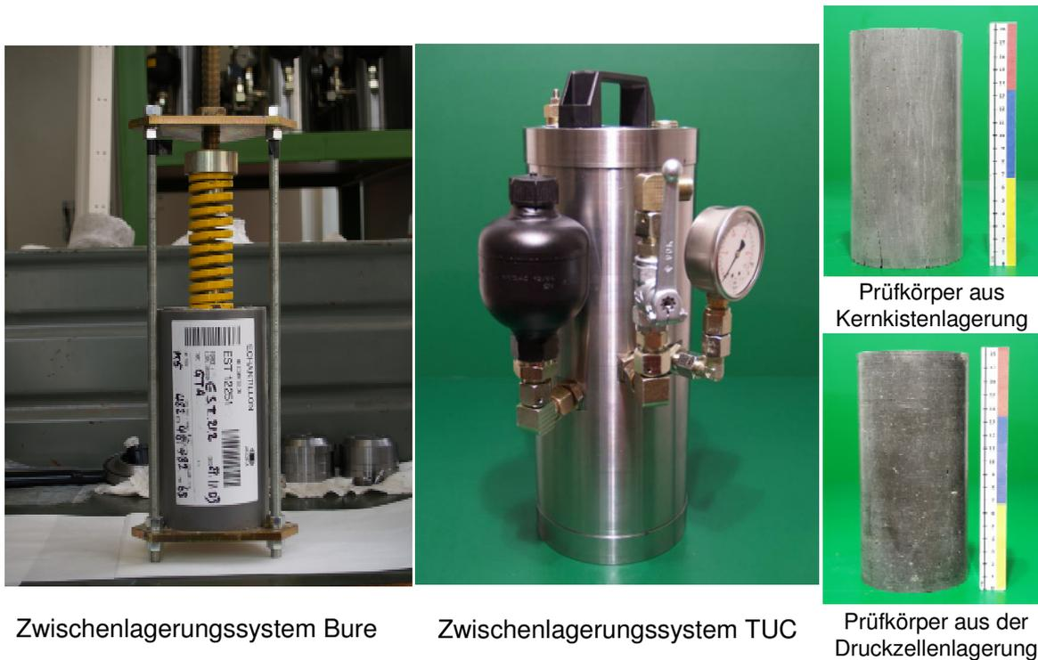
Bild 3.3: Zwischenlagerungssysteme für Tongestein
