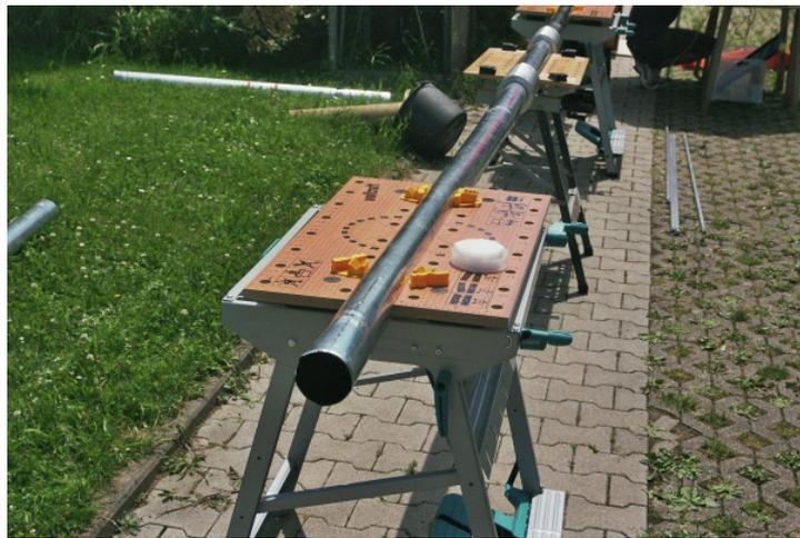
*Bild 4.17: Versuchsaufbau mit deformiertem Fallrohr zur Bohrlochsimulation*
