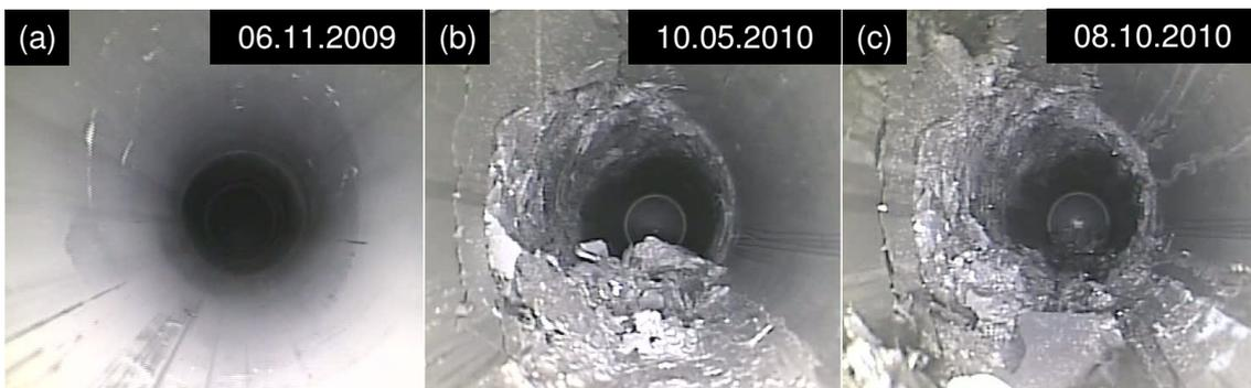
*Bild 4.82: Dokumentation der zeitabhängigen Entwicklung der Bohrlochwand im Teufenbereich von  $t_{BL} \approx 5,1$  m bis  $t_{BL} \approx 5,3$  m innerhalb des Observationszeitraums vom 06.11.2009 bis zum 08.10.2010*
