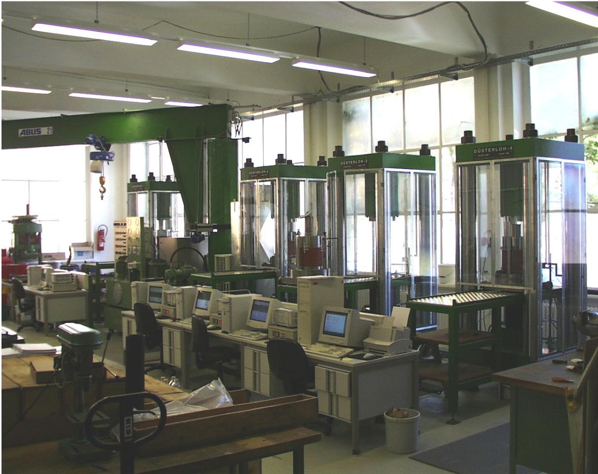
Bild 5.5: Triaxialprüfanlagen am Lehrstuhl für Deponietechnik und Geomechanik
