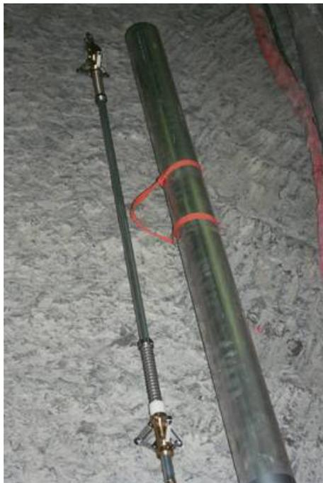
Bild 4.11: Dreiarmkalibersonde der TUC (links) mit Kalibrierrohr (rechts)
