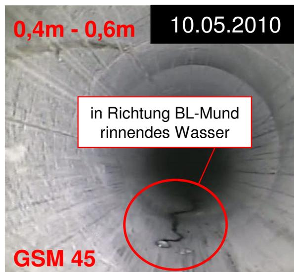
*Bild 4.107: In Richtung des Bohrlochmundes rinnendes Wasser innerhalb des Bohrlochs GSM 45 mit einem Wassertropfen an der Ausbreitungsfront*
