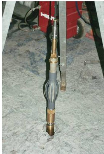
*Bild 4.2: ETIBS-Sonde bei der Einfahrt in ein Bohrloch*
