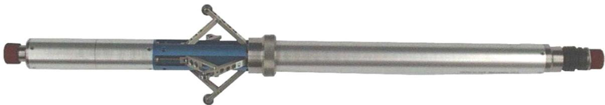
*Bild 4.6: Vierarmkalibersonde der Firma Glötzl, [www.gloetzl.de](http://www.gloetzl.de) (2008)*
