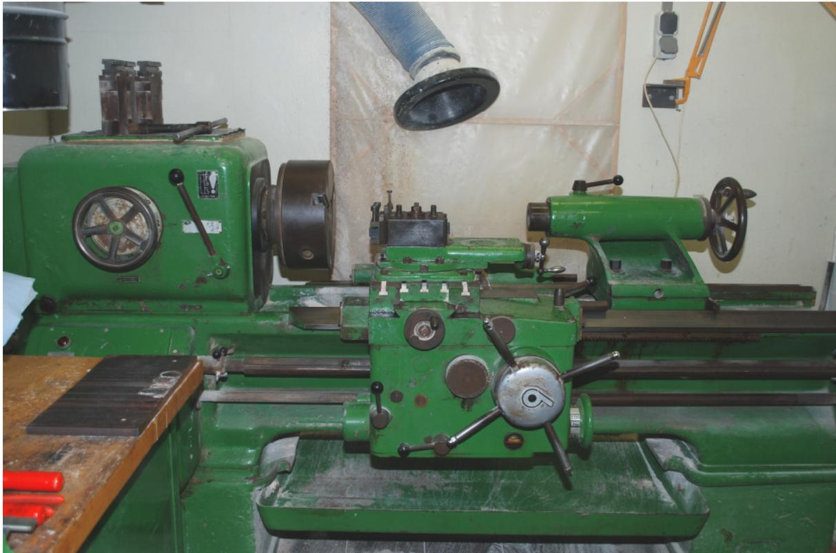
Bild 5.1: Drehbank zur Herstellung von Gesteinsprüfkörpern am Lehrstuhl für Deponietechnik und Geomechanik
