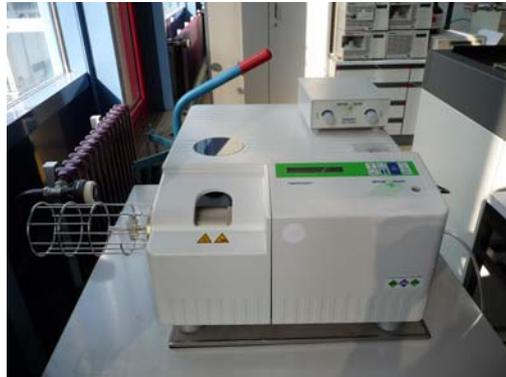
**Abbildung 39:** Thermogravimetrie mit Mettler/Toledo TGA/SDTA851<sup>®</sup>.
