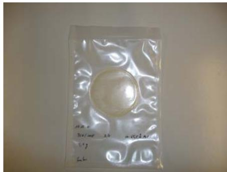
**Abbildung 23:** Eine für den Transport in PE-Folie eingeschweißte PVA/KOH – Elektrolytmembran
