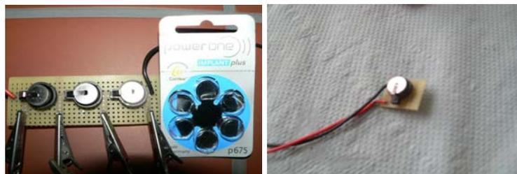
**Abbildung 109:** Versuchsvorrichtung für die Vermessung von kommerziellen Zn/Luft-Knopfzellen.
