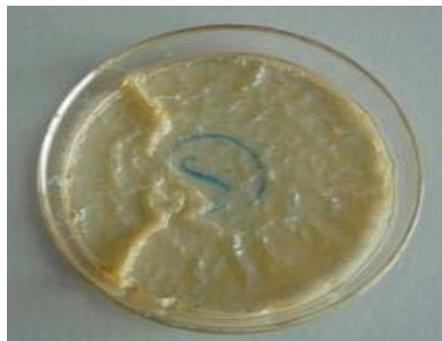
**Abbildung 22:** Ausgegossene PAA/PVA-Membran nach Aktivierung mit 6 molarer KOH.
