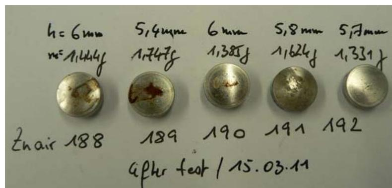
**Abbildung 107:** Einige Zn/Luft-Zellen von Feb. 2011 nach dem Lade-/Entladetest.
