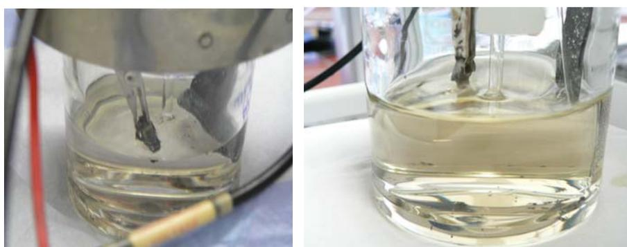
**Abbildung 68:** Versuchsanordnung mit der Zink-Arbeitslektrode, dem Luggingkappillar und C-Papier als Gegenelektrode am (links) Versuchsbeginn und (rechts) Versuchsende.
