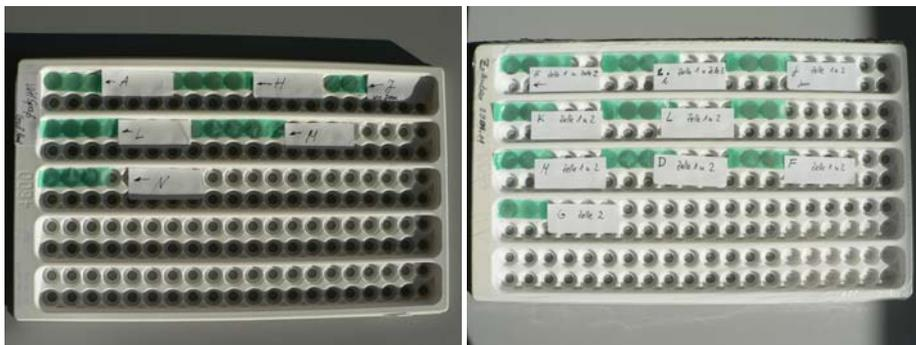
**Abbildung 102:** Zn/Luft-Zellen die (links) in Feb. und (rechts) in April bei der DECHEMA getestet wurden; Die richtige Reihenfolge der April-Probe lautet von oben links: H, I, J, K, L, M, D, E, F, G.
