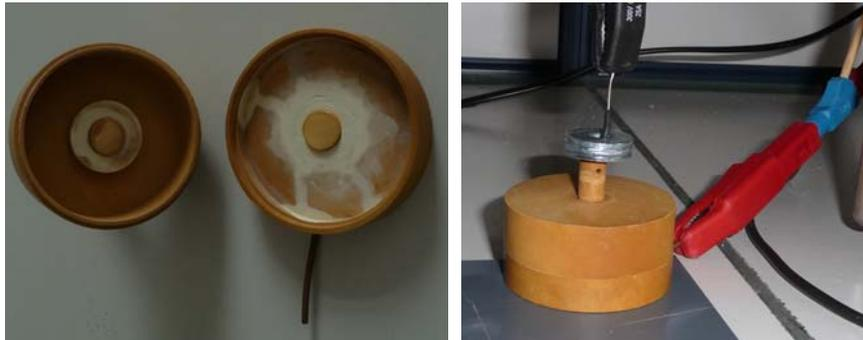
**Abbildung 24:** Test-Zelle mit blockierenden Goldelektroden für die Impedanzmessungen zur Ermittlung der spezifischen ionischen Leitfähigkeit von Elektrolytmembranen; links: geöffnete Zelle mit den beiden Goldelektroden; rechts: geschlossene Zelle mit den elektrischen Anschlüssen.
