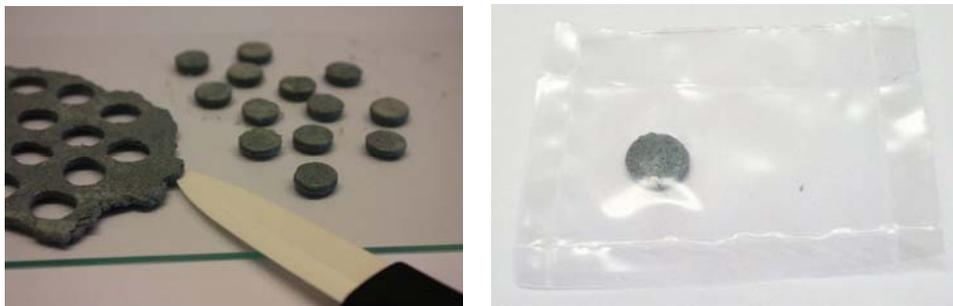
Abbildung 52: Zn-Pasten-Elektroden (Bilder: Fa. Brüggemann).
