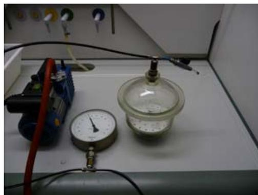
**Abbildung 41:** Apparatur zur Imprägnierung von porösen Zink – Anoden mit PVA - Lösung niedriger Viskosität ( PVA 30000 [Merck])
