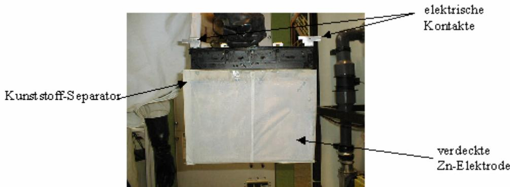
**Abbildung 3-1:** Aufgeladene Zn-Elektrode mit Separator
