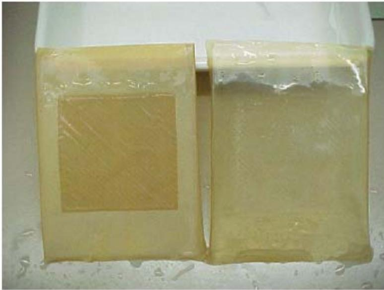
**Abbildung 5-6:** Links: beschädigte Fuma-Tech Anionenaustauschermembran Typ FT-FAB Rechts: Fuma-Tech Kationenaustauschermembran Typ FT-FKB
