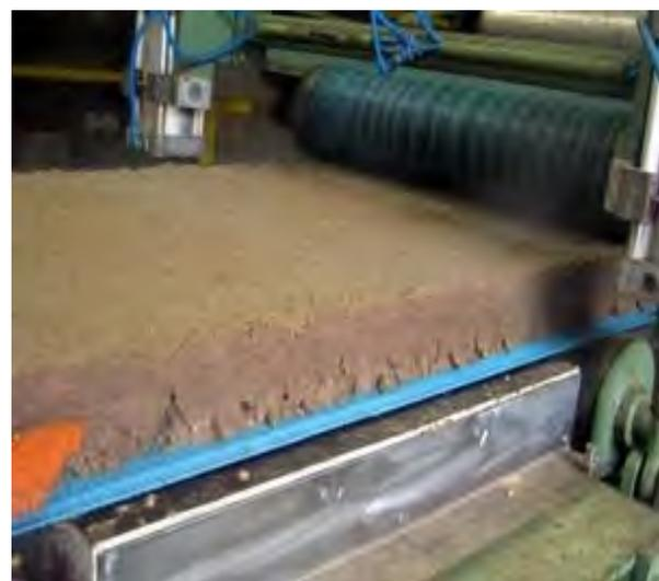
**Abb. 6.1.2.5-1 und 2: kontinuierliche Technikumsanlage zur Dämmplattenherstellung bei der Firma Gutex**
