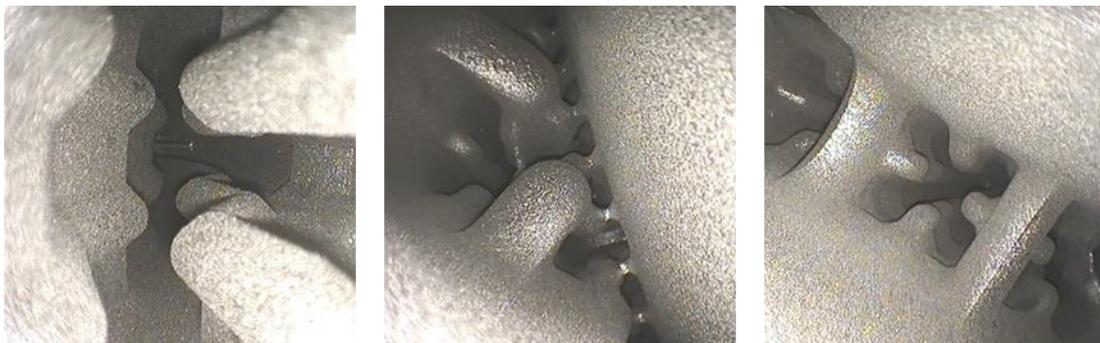
Abbildung 101: Videoendoskopie zur Sichtkontrolle der Kanalstrukturen im Bauteilinneren
