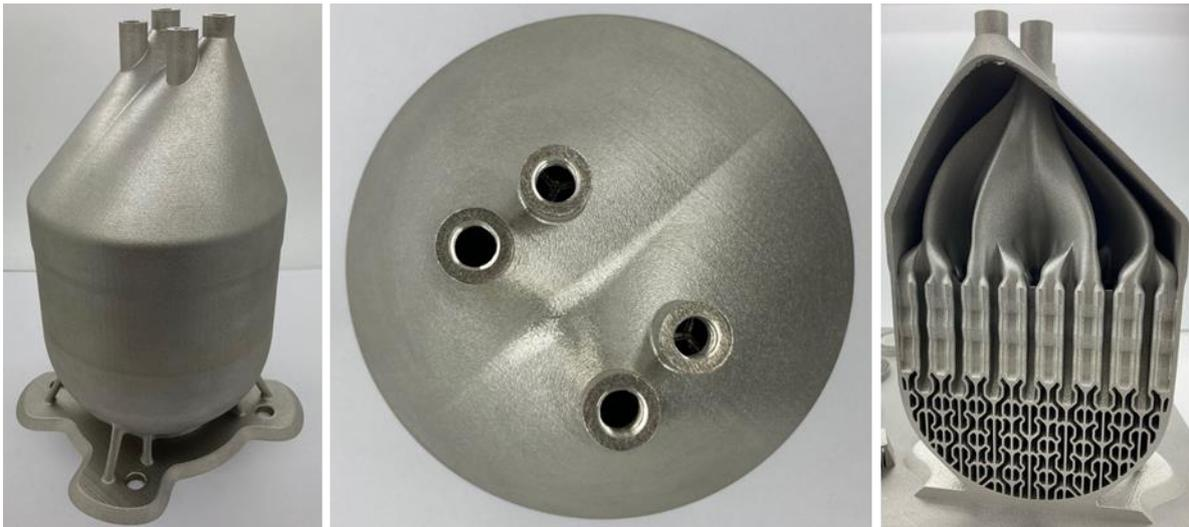
Abbildung 91: Fotografie Wärmetauscher-Demonstrator: Seitenansicht (links), Draufsicht (mitte), Halbschnitt (rechts)
