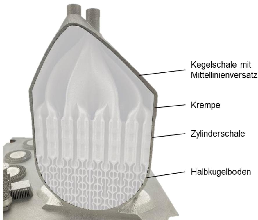
Abbildung 87: Fotografie der Wärmetauscher-Außengeometrie im Halbschnitt mit ausgegrauter Innenstruktur
