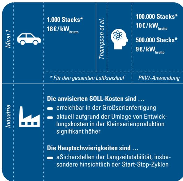
Die Erkenntnisse aus der Industrie beziehen sich auf die Kostenentwicklung des Kompressors für die Luftverdichtung. Dieser stellt als Einzelkomponente den größten Kostenfaktor im Kreislauf dar.
