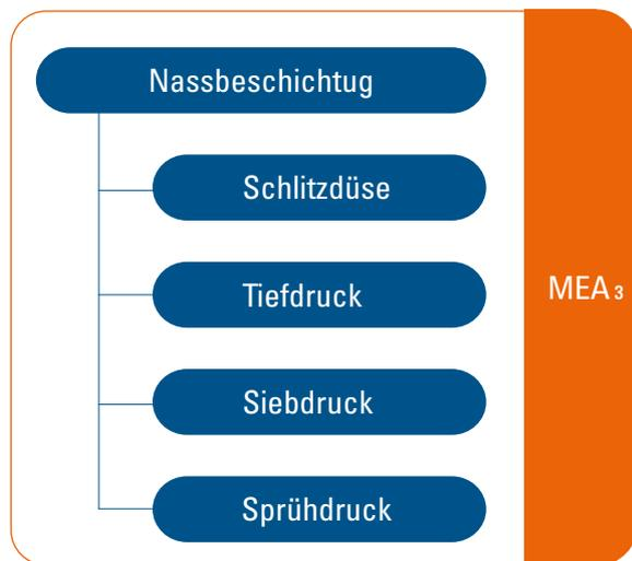
Beschichtungstechnologien können weitestgehend unabhängig von dem gewählten Beschichtungsverfahren (vgl. Abbildung 21) gewählt werden. Die verschiedenen Technologien müssen allerdings an die unterschiedlichen Tintenrezepturen und Membranen angepasst werden.
