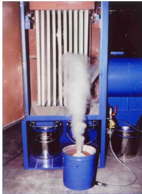
Abbildung 22: Injektion des Additives zum Schutz der Filterelemente
