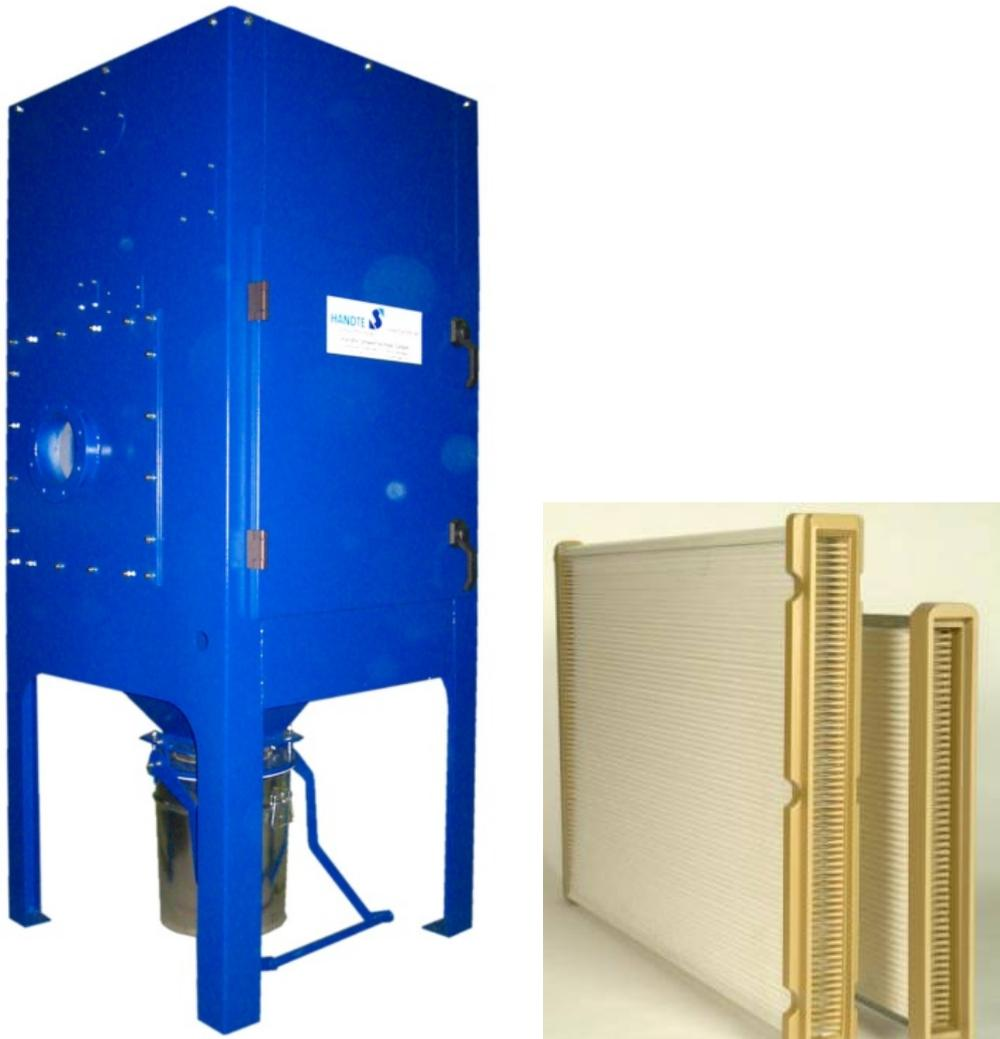
Abbildung 24: Finaler Musteraufbau (links) und verwendete Filterelemente (rechts)
