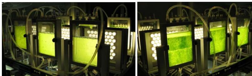
Abbildung 26: *Chlamydomonas reinhardtii* kultiviert in Mini-Plattenreaktoren, links mit Glaseinbauten ohne Zellanhaftungen
