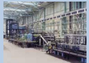
Kontinuierliche Bandversuchsanlage für neue Technologien BPA 300
