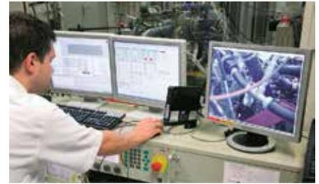
Dynamischer Motorprüfstand zur Untersuchung von Autoabgaskatalysatoren, Quelle: Umicore AG & Co. KG
