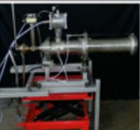
Abb. 6: Mobile Filtersonde
