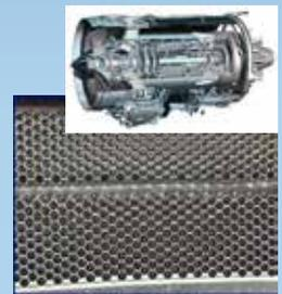
Honigwabenstruktur mit gewalzten, umgeformten und gelöteten Zellenprofil (material- und energieintensive Fertigung) für den Einsatz in Mantelstromtriebwerken
