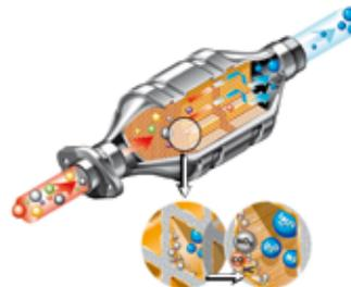
Heutzutage ist jedes kommerziell erhältliche Benzinfahrzeug mit einem Drei-Wege-Katalysator ausgerüstet. Der Drei-Wege-Katalysator ist damit der am weitesten verbreitete katalytische Reaktor der Welt.
