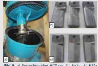
Bild 9: a) Versuchslicher R08 der Fa. Eirich, b) PTA-gepanzerte Rührwerkzeuge der Fa. Durum, c) Laser-gepanzerte Rührwerkzeuge der Fa. Riwalas
