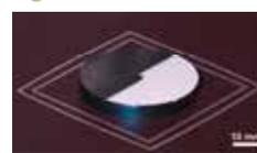
Laserbeschichtung von 100Cr6-Shims mit PEEK-Dispersion
