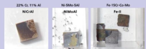
Proben nach Auslagerung in Luft (1000 °C, 10h)
