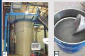
Bild 5: a) Demonstratoranlage DEW-Werk Hagen zur TiC-Rückgewinnung, b) In der Demonstratoranlage zurückgewonnenes TiC
