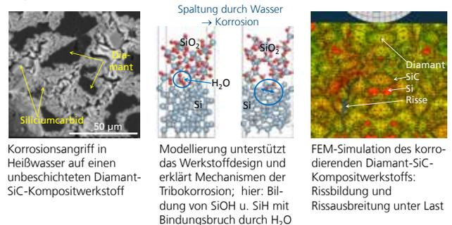
Korrosionsangriff in Heißwasser auf einen unbeschichteten Diamant-SiC-Kompositwerkstoff
