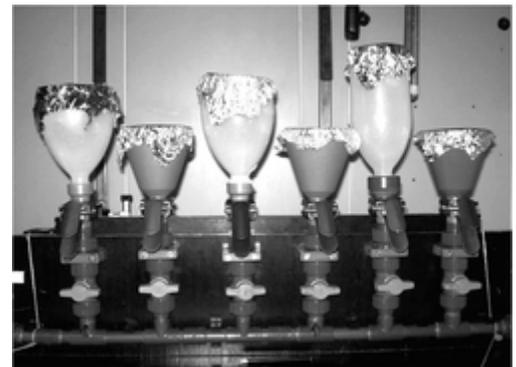
Vorrichtung zur Filtration von Seewasserproben
