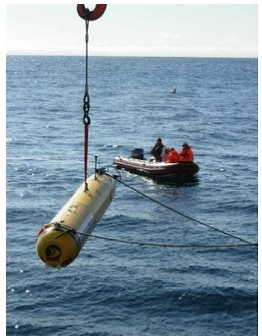
Ausbringung des Autonomen Unterwasserfahrzeugs (AUV) (© T. Soltwedel, AWI)
