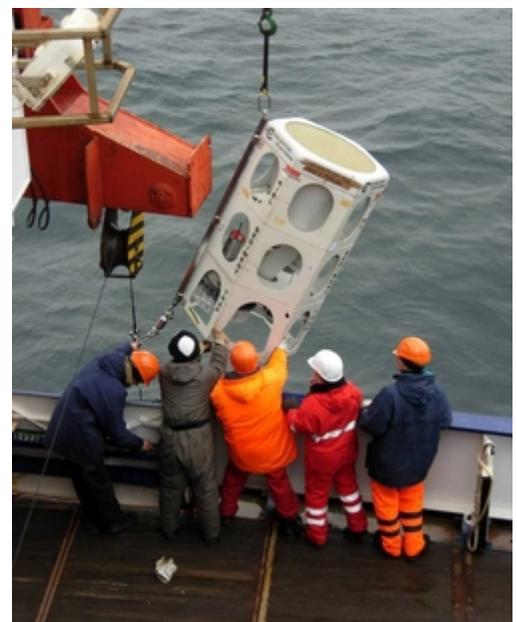
Um verschiedene physikalische, chemische und biologische Eigenschaften des Meerwassers zu untersuchen werden an allen HAUSGARTEN-Stationen Wasserproben mit der sogenannten CTD/Rosette gewonnen. Dieses Gerät kombiniert eine Reihe von Sensoren mit einem Kranz aus
