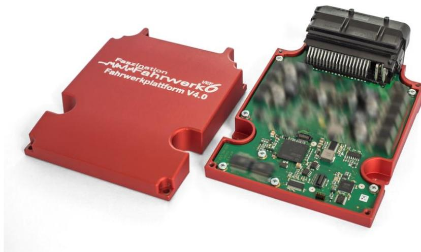
Abbildung 1 zeigt die Steuergeräte-Hardware der Audi-Demonstratorplattform
