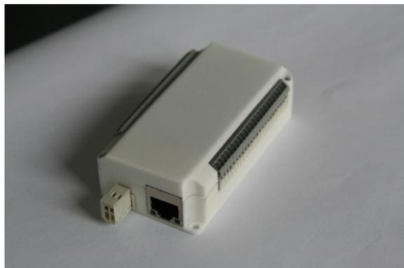
Im Rahmen des Projektes AutoPnP wurde ein Gehäuse für die Steuerungsplattform „Effectuator“ konstruiert. Damit wird die Benutzerfreundlichkeit deutlich gesteigert, insbesondere wird die Verdrahtung von Anschlüssen durch Stecker und Klemmen deutlich vereinfacht.
