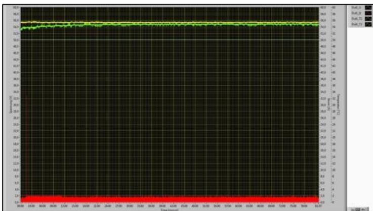
**Abbildung 20: externer Kurzschlussstest (T5) an inaktiver Batterie D bei 55°C und Widerstand von 75mΩ**
