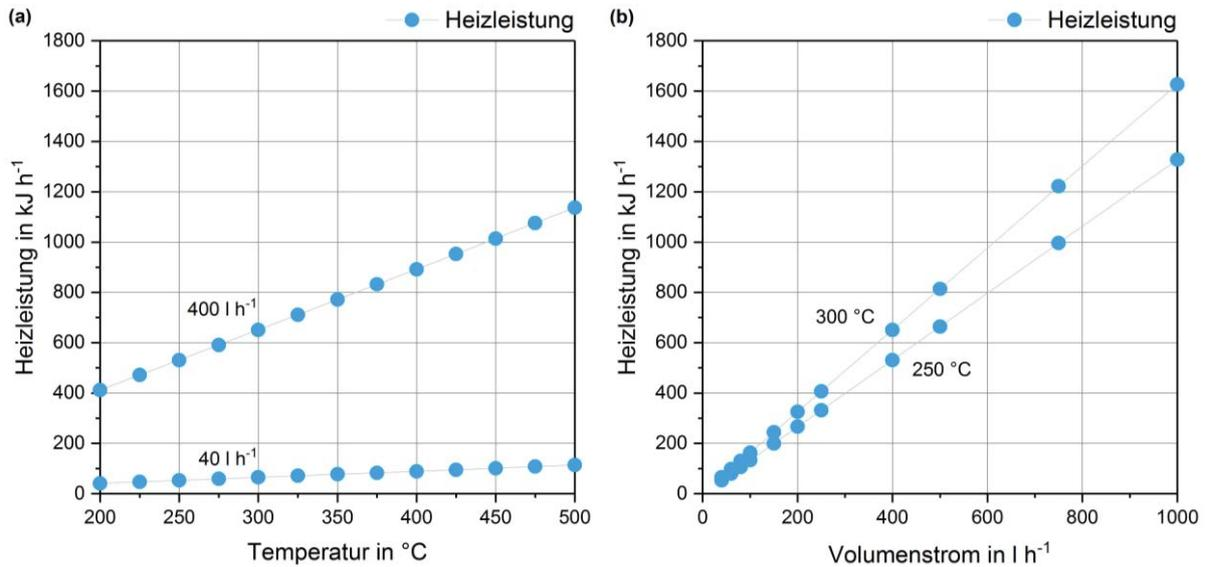
Abb. 40 Notwendige Leistung zum Aufheizen der Standardgaszusammensetzung (41,25 Vol.-%  $\text{H}_2$ , 13,75 Vol.-%  $\text{CO}$ , 45,00 Vol.-%  $\text{N}_2$ ) unter konstantem Druck (5 bar) bei (a) konstantem Volumenstrom (40 und  $400 \text{ l h}^{-1}$ ) und (b) konstanter Temperatur (250 und  $300 \text{ }^{\circ}\text{C}$ )
