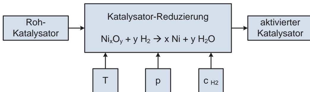
Abb. 11 System "Katalysator-Reduzierung": Potentielle Einflussfaktoren auf die Aktivierung des untersuchten Ni/Al<sub>2</sub>O<sub>3</sub>- Katalysators
