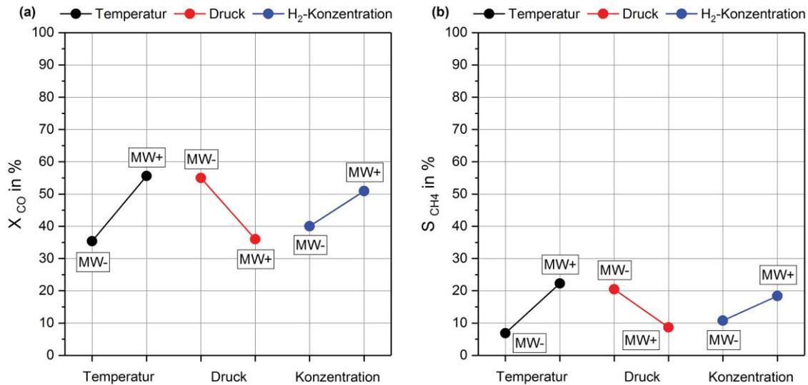
Abb. 14 Graphische Darstellung der Effekte für  $X_{CO}$  (a) und  $S_{CH_4}$  (b) (Messreihe 1). Diese ergeben sich aus der Differenz der Mittelwerte der Ergebnisse bei der höheren (MW+) und der niedrigeren (MW-) Stufe der drei Faktoren.
