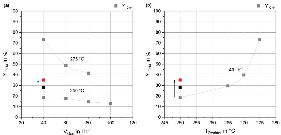
Abb. 39 Vergleich der Ergebnisse der Methanisierung (CH<sub>4</sub>-Ausbeute) bei 250 °C mit den Ergebnissen der Vorversuche (Kap. 4.1) bei H<sub>2</sub>/CO = 3/1 (schwarz, Kap. 5.1.3) und 4/1 (rot, Kap. 5.2.1)
