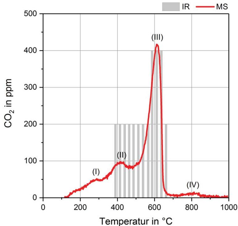
Abb. 23 Temperaturaufgelöste Darstellung der CO<sub>2</sub>-Menge (IR bzw. MS) der Probe 5. Die Beschriftungen (I) bis (IV) kennzeichnen die unterschiedlichen Kohlenstoffmodifikationen
