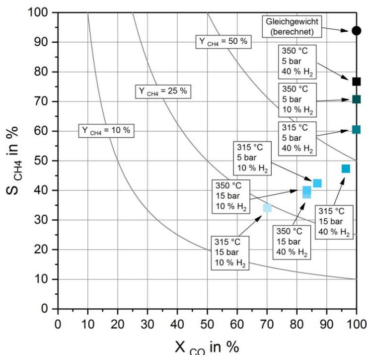
Abb. 15 Ergebnisse der unterschiedlich aktivierten Katalysatoren der zweiten Charge in der Methanisierung bei 275 °C und 5 bar, sowie das mit Aspen Plus<sup>®</sup> berechnete Gleichgewicht. In den Kästen sind die Aktivierungsbedingungen für jeden Versuchspunkt aufgeführt.
