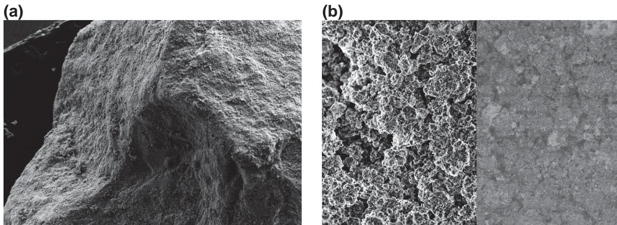
Abb. 5 SEM-Aufnahme des in Messreihe 1 (Kap. 5.1.2) verwendeten  $\text{Ni}/\text{Al}_2\text{O}_3$ -Katalysators (Charge 1) mit 137-facher (a) und 10.000-facher (b) Vergrößerung (b – links Sekundärelektronen, rechts Rückstreuielektronen) (aus [Schneider 2013])
