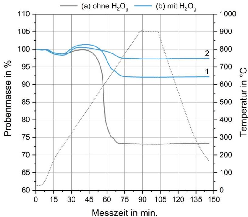
Abb. 27 Thermogravimetrie-Messung der Proben zur Bestimmung der abgelagerten Kohlenstoffmenge; Durchschnittsprobe des Katalysatorbettes aus dem Versuchs ohne H<sub>2</sub>O-Zugabe (grau), sowie ortsaufgelöste Probenentnahme aus dem Versuch mit H<sub>2</sub>O-Zugabe am Anfang (blau - 1) und am Ende (blau - 2) des Katalysatorbettes.
