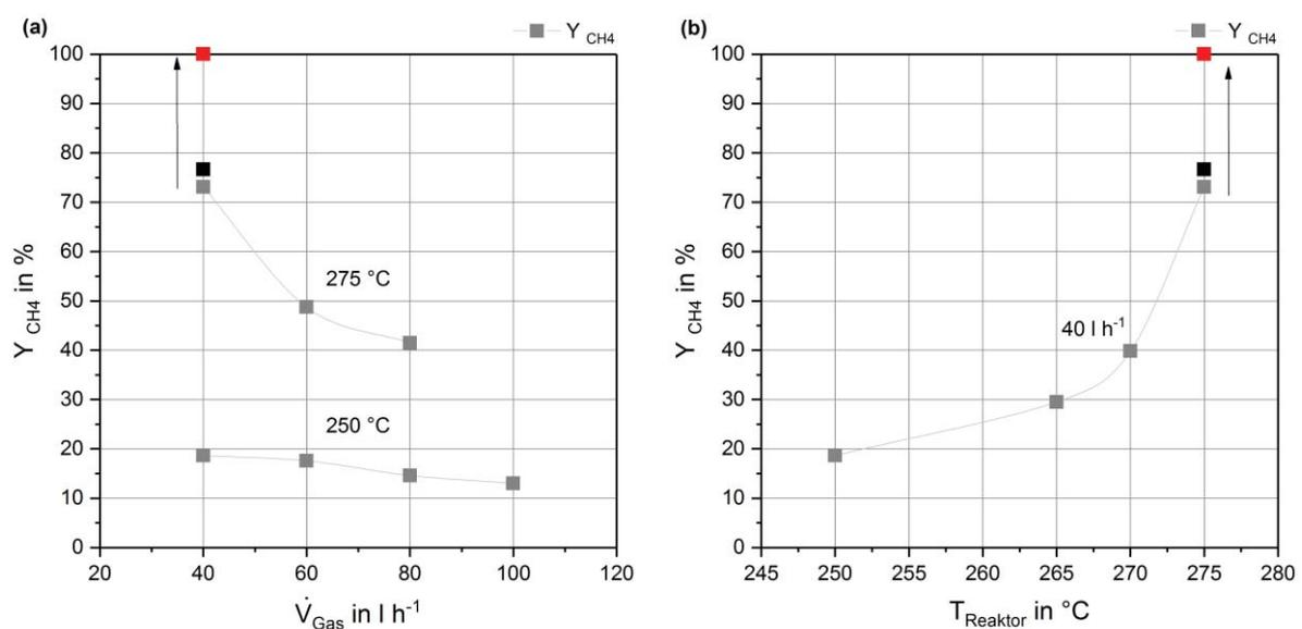
Abb. 36 Vergleich der Ergebnisse der Methanisierung ( $CH_4$ -Ausbeute) bei 275 °C mit den Ergebnissen der Vorversuche (Kap. 4.1) bei  $H_2/CO = 3/1$  (schwarz, Kap. 5.1.3) und  $4/1$  (rot, Kap. 5.2.1)
