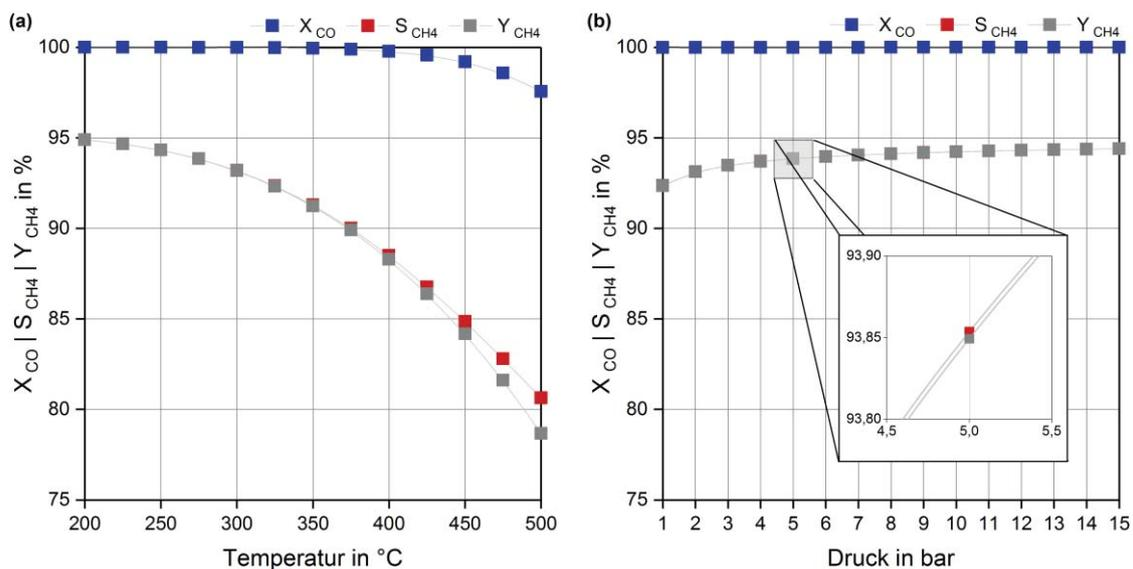
Abb. 9 Einfluss von Temperatur und Druck auf den CO-Umsatz ( $X_{CO}$ ), die  $CH_4$ -Selektivität ( $S_{CH_4}$ ) und die  $CH_4$ -Ausbeute ( $Y_{CH_4}$ ) der CO-Methanisierung und Wassergas-Shift-Reaktion im Gleichgewicht. Dargestellt sind die Ergebnisse bei 5 bar (a) bzw. 275 °C (b). Die Daten wurden mit Aspen Plus<sup>®</sup> berechnet.
