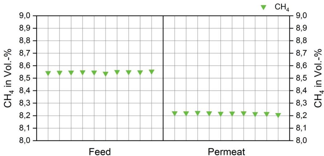
Abb. 35 Untersuchung der Membran bezüglich der Abtrennung von Methan aus dem Produktgasstrom. Dargestellt ist die Methan-Konzentration im Feed und im Permeat vor bzw. hinter der Membraneinheit über einen Zeitraum von je etwa 30 Minuten
