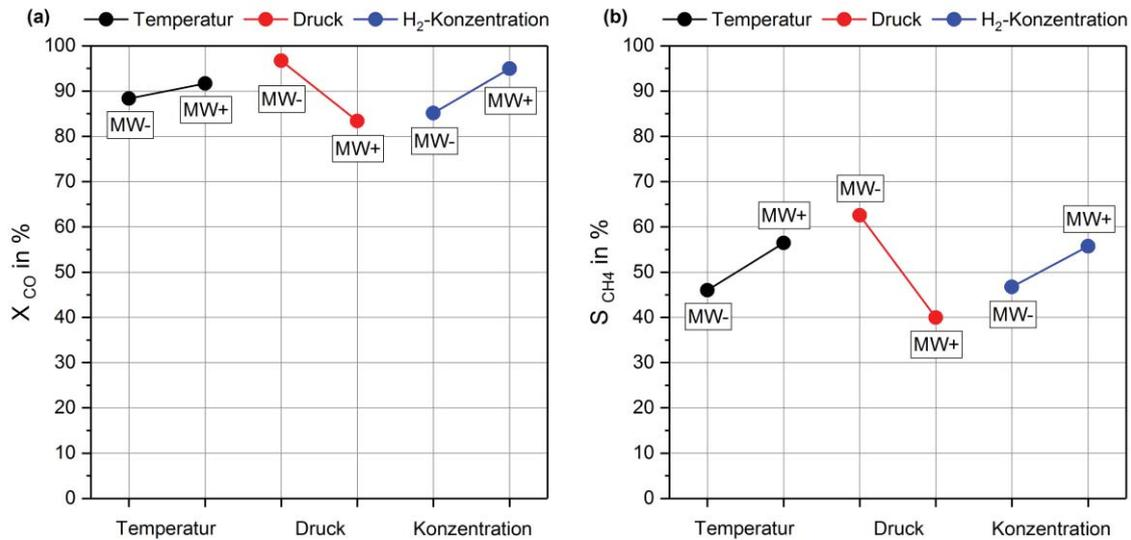
Abb. 16 Graphische Darstellung der Effekte für  $X_{CO}$  (a) und  $S_{CH_4}$  (b) (Messreihe 2). Diese ergeben sich aus der Differenz der Mittelwerte der Ergebnisse bei der höheren (MW+) und der niedrigeren (MW-) Stufe der drei Faktoren.
