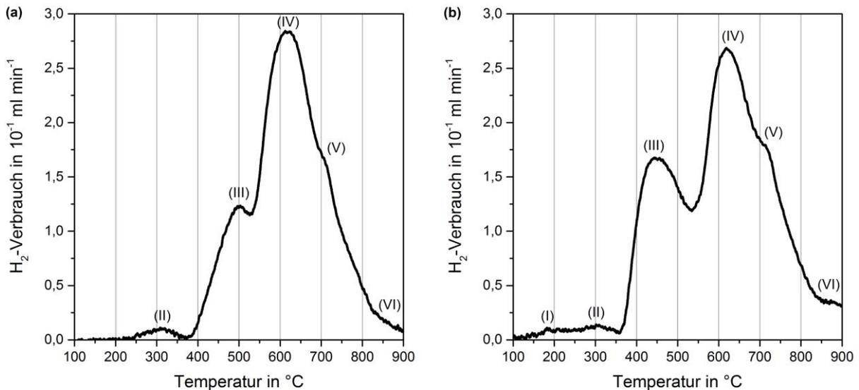
Abb. 6 TPR-Profile der verwendeten Ni/Al<sub>2</sub>O<sub>3</sub>-Katalysatoren, (a) Charge 1, (b) Charge 2. Die Beschriftungen (I) bis (VI) kennzeichnen unterschiedliche Ni<sub>x</sub>O<sub>y</sub>-Spezies auf der Katalysatoroberfläche (vgl. Tab. 5)
