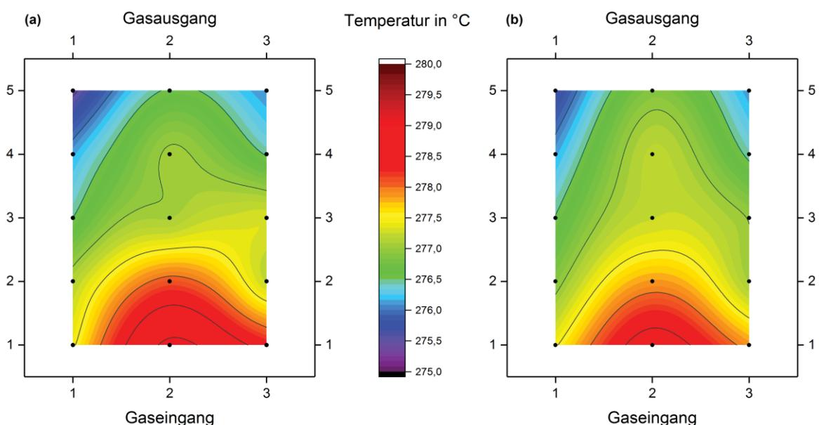
Abb. 31 Temperaturverteilung innerhalb des Katalysatorbettes im Plattenreaktor (a) zu Beginn ( $t = 0 \text{ min}$ ) und (b) am Ende der Messzeit ( $t = 160 \text{ min}$ ), Starttemperatur:  $275 \text{ }^\circ\text{C}$
