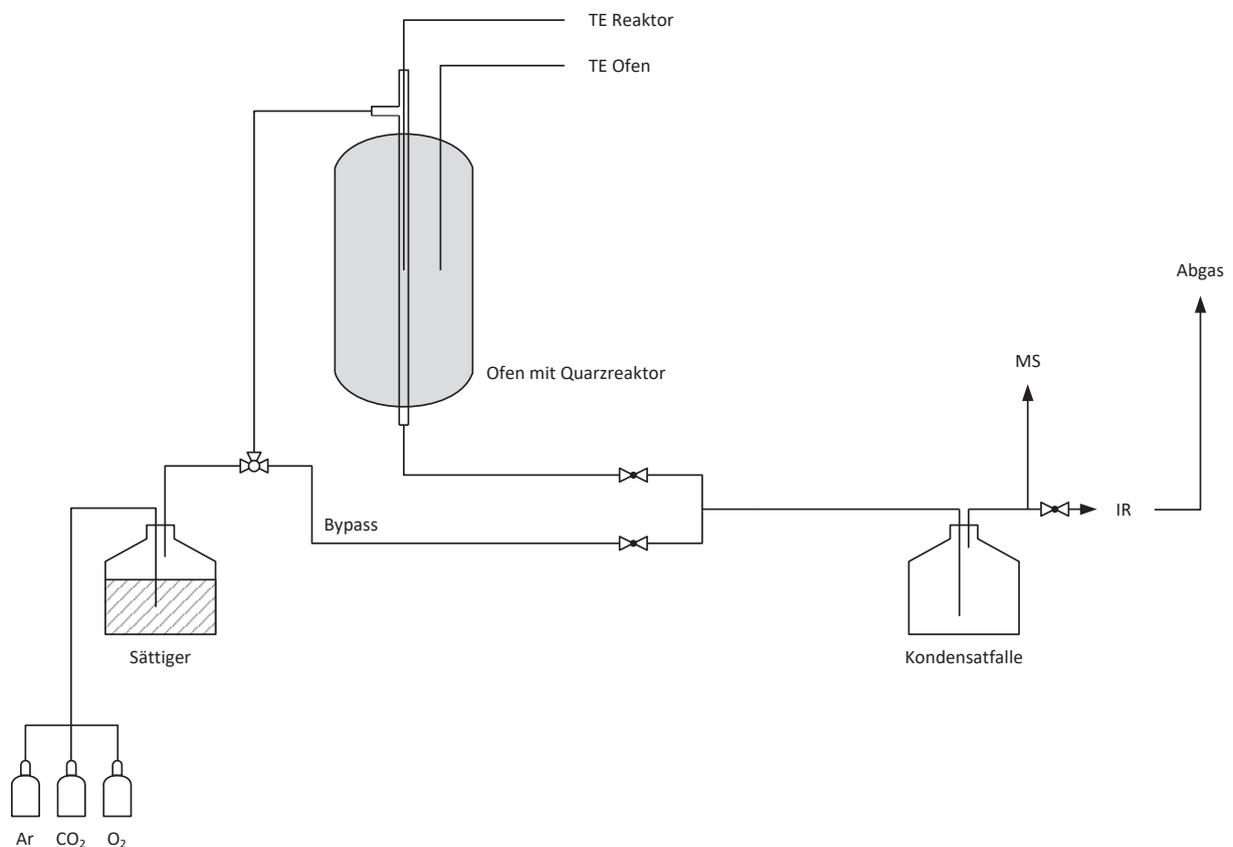
Abb. 46 Fließbild des für die Messung der Kohlenstoffablagerungen verwendeten Versuchsaufbaus
