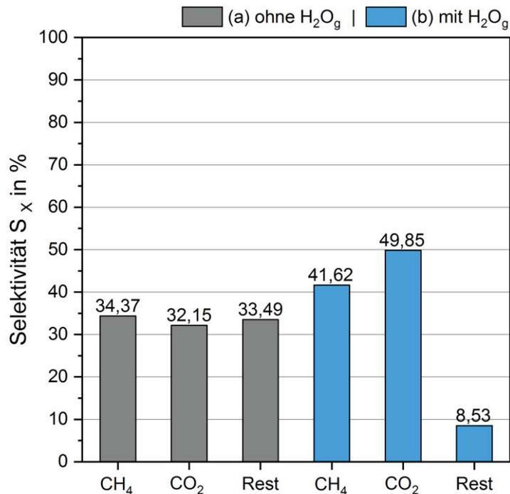
Abb. 26 Mittlere Selektivitäten gegenüber CH<sub>4</sub> und CO<sub>2</sub> des Katalysators der ersten Charge beim Test der realen Güssing-Gaszusammensetzung im Rohrreaktor jeweils ohne und mit H<sub>2</sub>O, der CO-Umsatz betrug in beiden Fällen etwa 92 %
