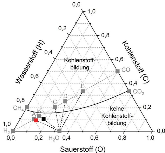
Abb. 24 Ternäres HCO-Diagramm auf Grundlage von [Bartholomew 1982] und [Frick 2014]. Dargestellt sind die Einzelkomponenten der Methanisierung sowie ausgewählte Gaszusammensetzungen (A:  $H_2/CO = 4/1$ , B:  $3/1$ , C:  $1,5/1$ , D:  $1/1$ , E:  $0,5/1$ , jeweils ohne  $H_2O$ ; sowie rot:  $4/1$ ,  $H_2O_g = 5 \text{ Vol.-%}$ , schwarz:  $3/1$ ,  $H_2O_g = 10 \text{ Vol.-%}$ ). Die schwarze Kurve grenzt den Bereich der wahrscheinlichen Kohlenstoffbildung ab und basiert auf Literaturdaten.
