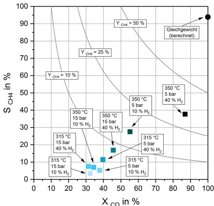
Abb. 13 Ergebnisse der unterschiedlich aktivierten Katalysatoren der ersten Charge in der Methanisierung bei 275 °C und 5 bar, sowie das mit Aspen Plus<sup>®</sup> berechnete Gleichgewicht. In den Kästen sind die Aktivierungsbedingungen für jeden Versuchspunkt aufgeführt.
