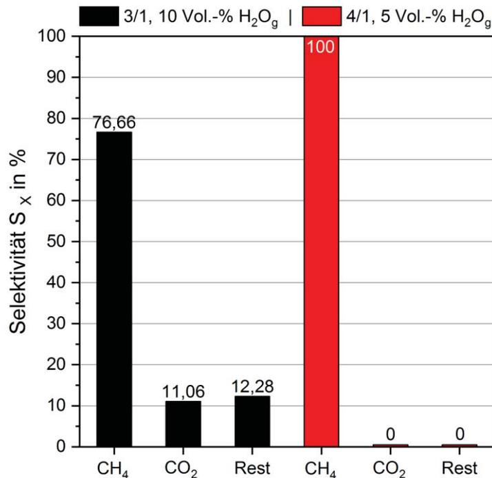
Abb. 18 Mittlere Selektivitäten gegenüber CH<sub>4</sub> und CO<sub>2</sub> des gleichen Katalysators (Charge 2, Aktivierung Nr. 6) bei unterschiedlichen Eduktgaszusammensetzungen (schwarz: H<sub>2</sub>/CO = 3/1, 10 Vol.-% H<sub>2</sub>O<sub>g</sub>; rot: H<sub>2</sub>/CO = 4/1, 5 Vol.-% H<sub>2</sub>O<sub>g</sub>, vgl. Tab. 15), der CO-Umsatz (X<sub>CO</sub>) betrug in beiden Fällen 100 %.
