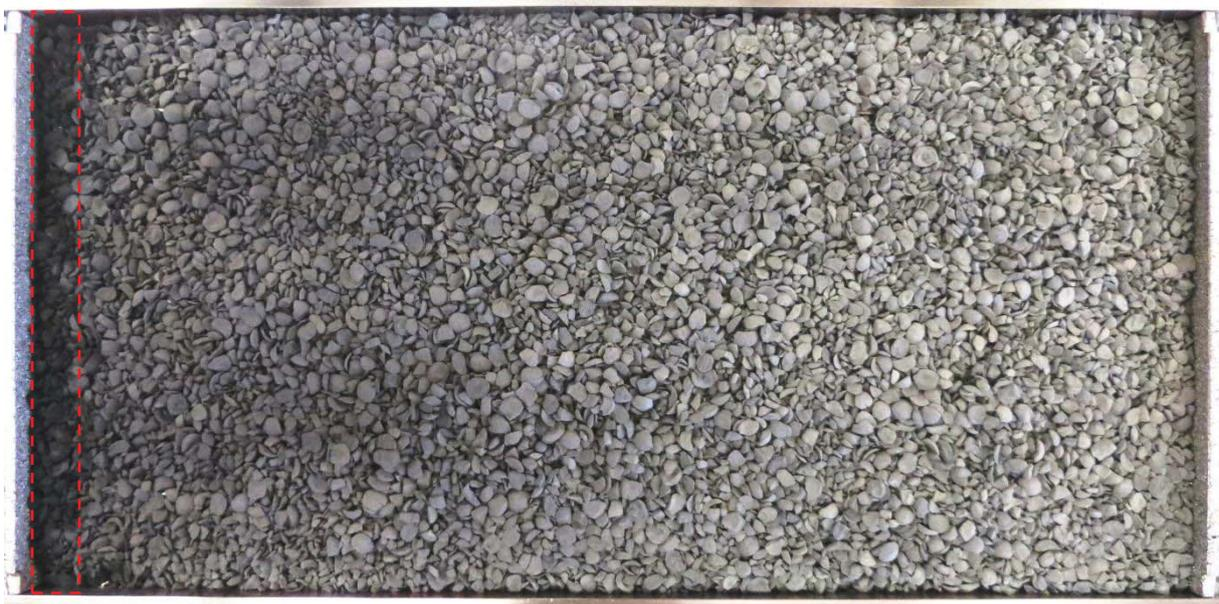
*Abb. 19 Katalysatorbett im Plattenreaktor nach der Methanisierung (Ansicht von oben, Gasflussrichtung von links nach rechts); die Probenahme erfolgte am Anfang des Katalysatorbettes als Durchschnittsprobe über die Breite des Reaktors innerhalb des roten Rahmens (Bild: M. Schlüter)*
