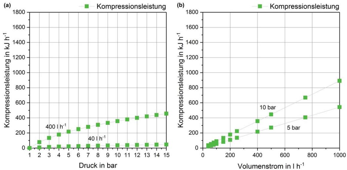
Abb. 41 Notwendige Leistung zum einstufigen Komprimieren der Standardgaszusammensetzung (41,25 Vol.-%  $\text{H}_2$ , 13,75 Vol.-%  $\text{CO}$ , 45,00 Vol.-%  $\text{N}_2$ ) unter konstanter Temperatur ( $250^\circ\text{C}$ ) bei (a) konstantem Volumenstrom (40 und  $400 \text{ l h}^{-1}$ ) und (b) konstantem Druck (5 und 10 bar)
