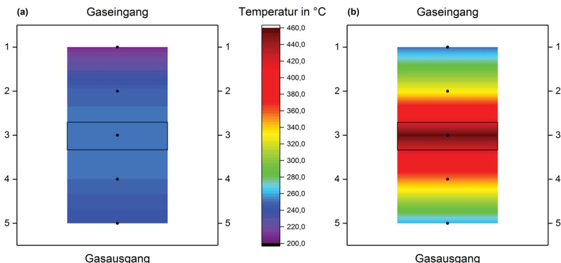
Abb. 29 Temperaturverteilung innerhalb des Rohrreaktors (a) zu Beginn ( $t = 0$  min) und (b) am Ende der Messzeit ( $t = 250$  min), Starttemperatur: 250 °C; das Katalysatorbett befindet sich auf Höhe der Messstelle 3 (schwarzer Kasten)
