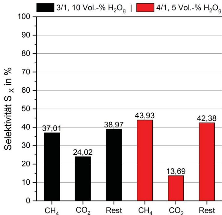
Abb. 38 Vergleich der Selektivitäten aus der Methanisierung bei 250 °C und H<sub>2</sub>/CO = 3/1 (schwarz) bzw. 4/1 (rot). Der CO-Umsatz betrug 76 % (3/1) bzw. 80 % (4/1)
